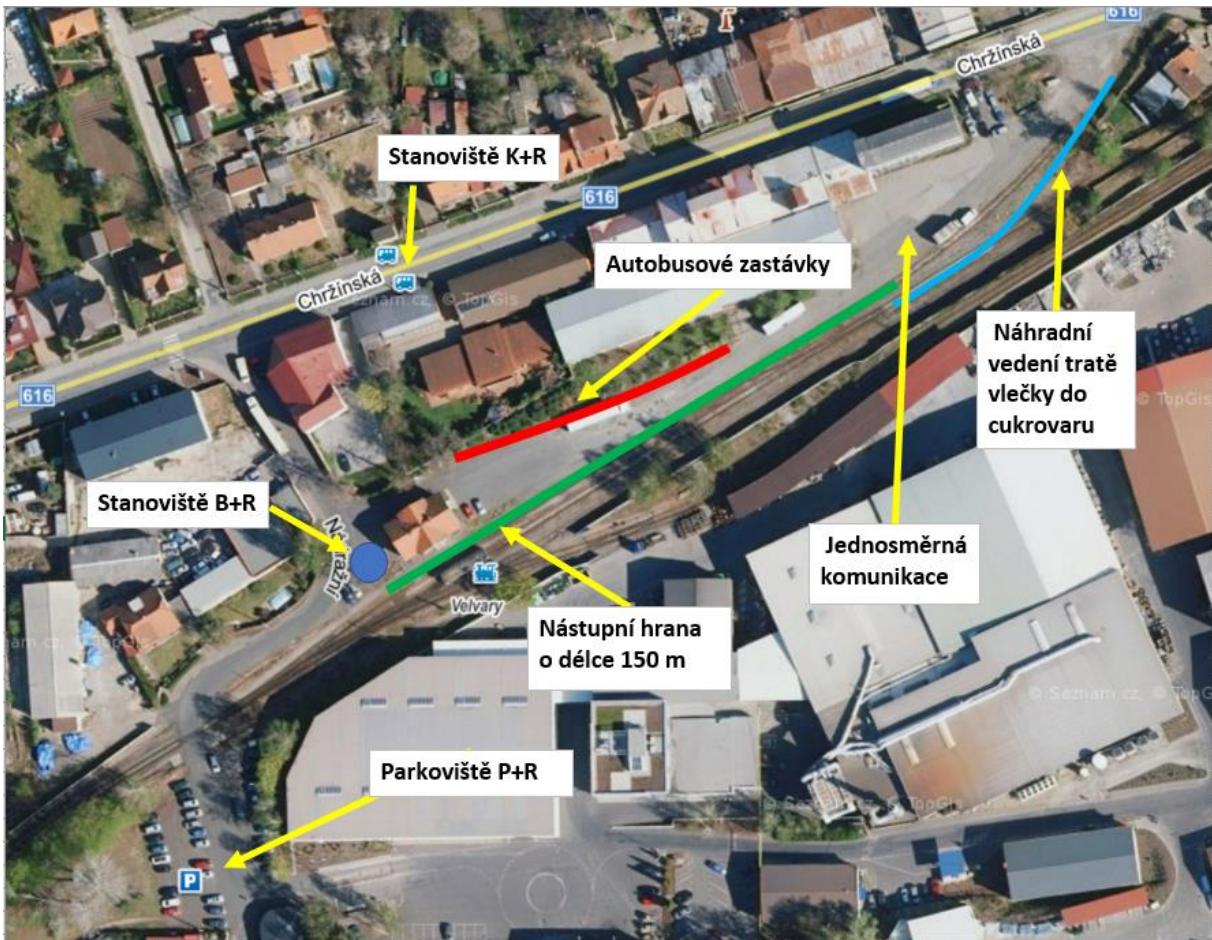
Obrázek 28 – První varianta vybudování přestupního terminálu Velvary [38]
