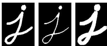
Obrázek 2.7: Aplikace základních morfologických operací: vlevo originální obrázek, uprostřed snímek po aplikaci eroze, vpravo snímek po aplikaci dilatace. [24]
