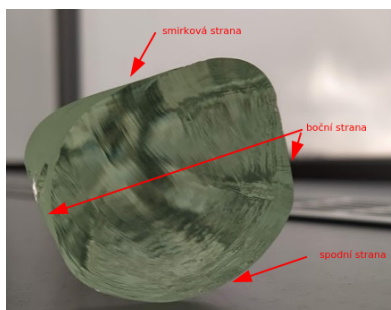
Obrázek 1.1: Řez optické tyče.
