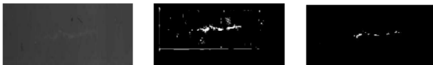
Obrázek 1.8: Algoritmus předzpracování snímků. Vlevo je originální snímek, uprostřed snímek po aplikaci Sauvolova prahování, vpravo segmentovaný snímek.
