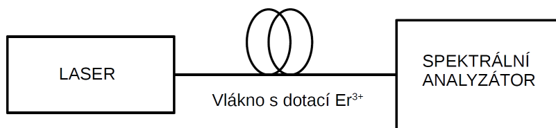
Obrázek 8: Schéma zapojení pro měření spektrální charakteristiky dotovaných vláken [21].
