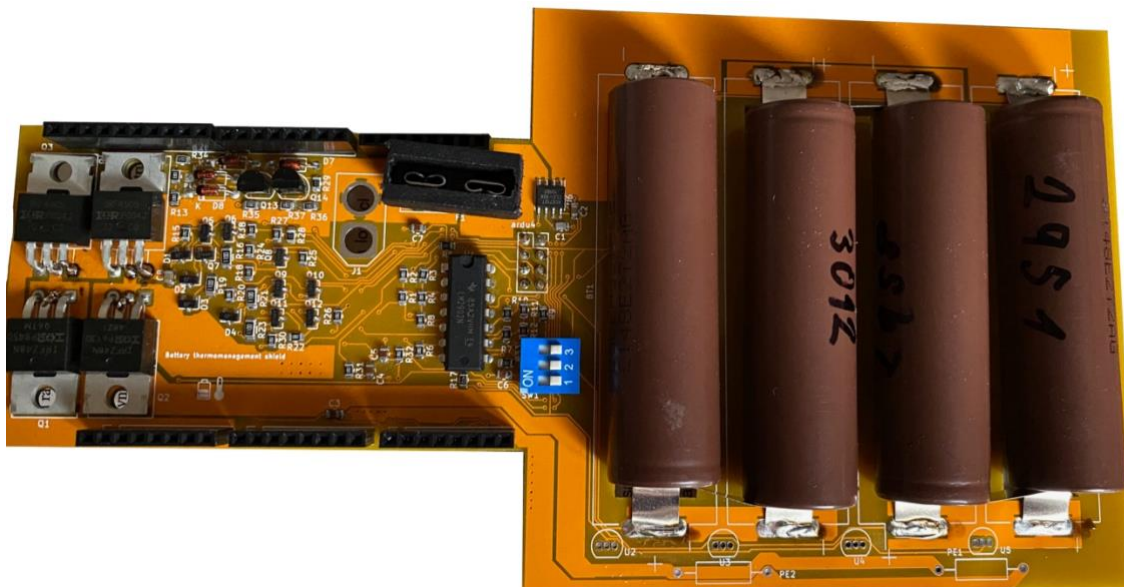
Obr. 16: Přípravek po spojení s články baterie
