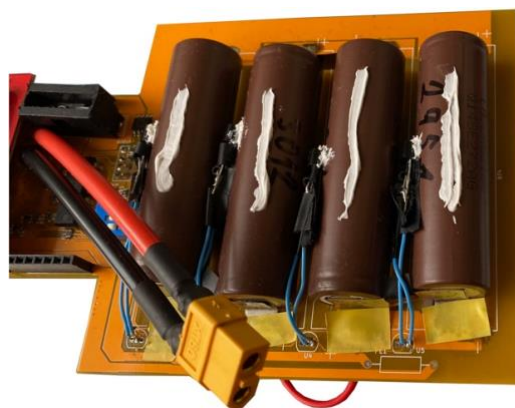
Obr. 18: Články baterie s nanesenou teplovodivou pastou
