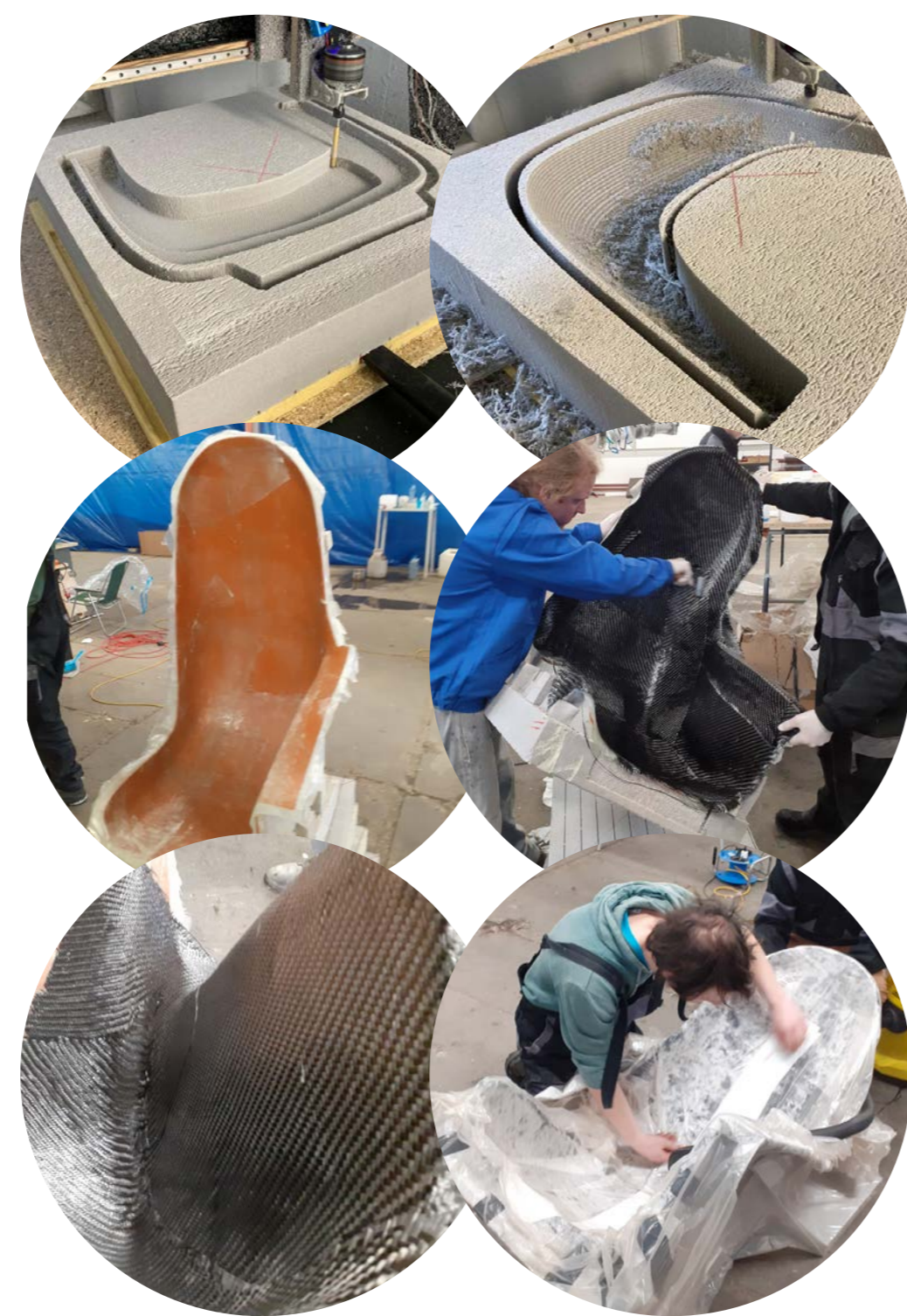
obr. 097, 098, 099, 100, 101, 102 - výroba mock-upu sedačky
