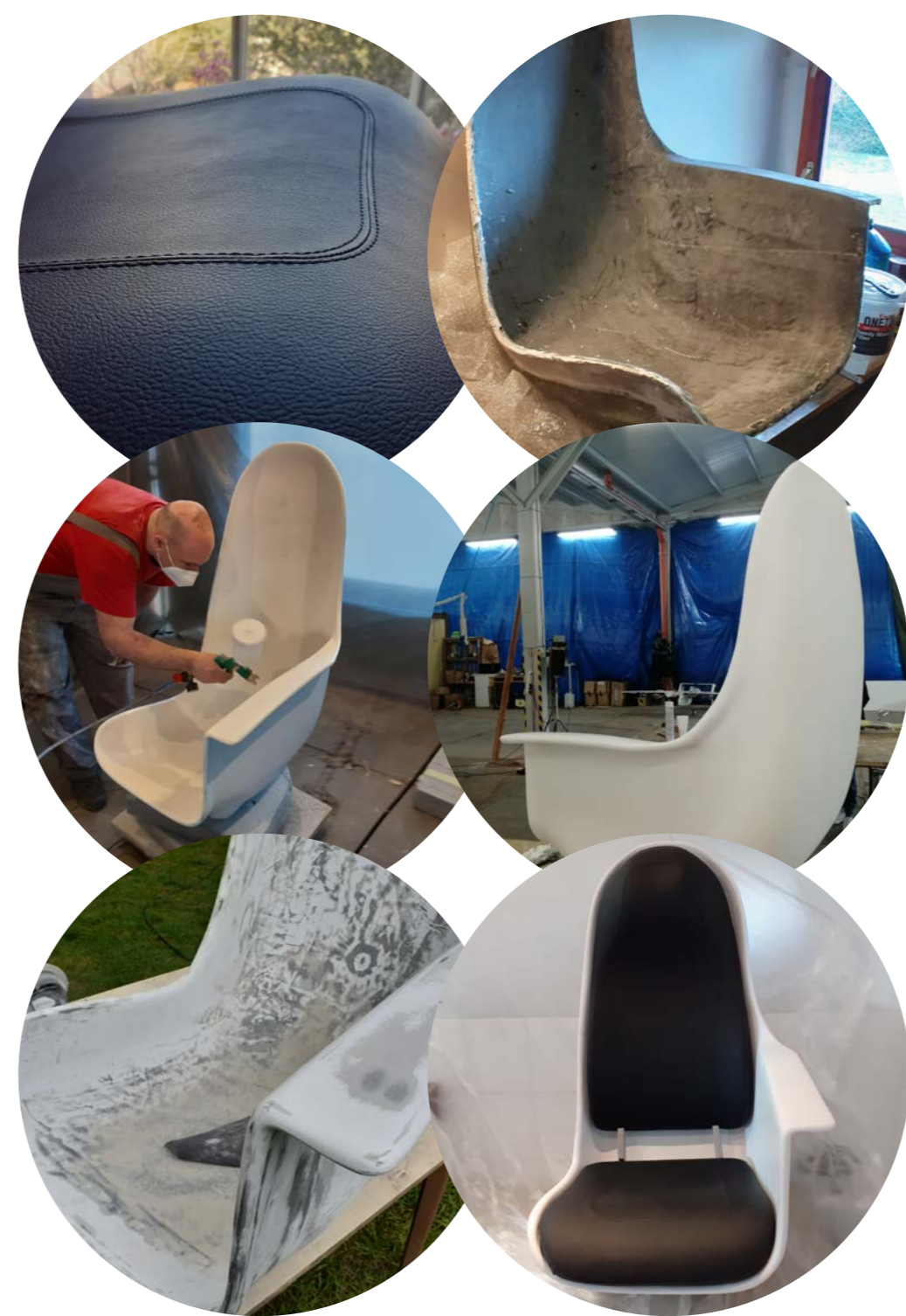
obr. 103, 104, 105, 106, 107, 108, 109 - výroba mock-upu sedačky
