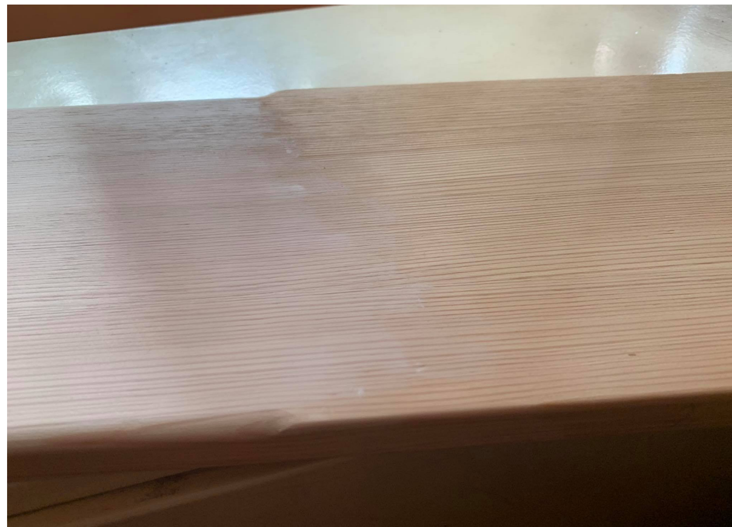
obr. 59 Zkouška barvy, zkouška zaoblení.
