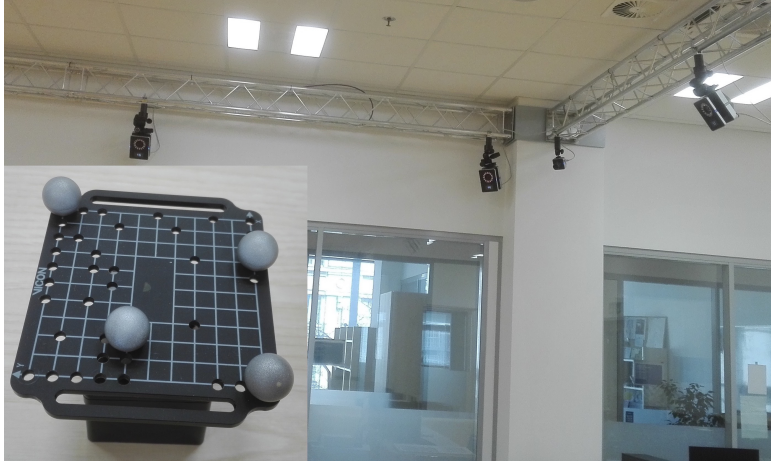
Obrázek 4.1: Lokalizační systém Vicon v testovací laboratoři a detekční kuličky
