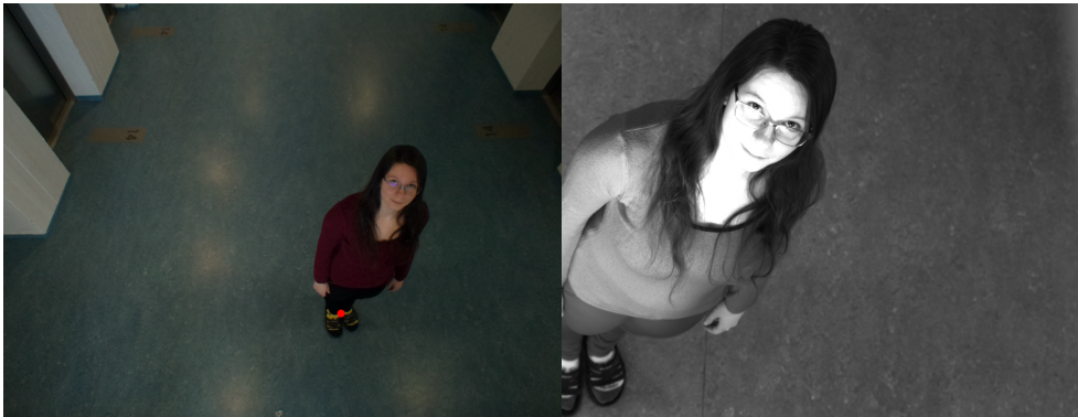
Obrázek 5.18: Měření 2: Vlevo snímek z přehledové kamery s postavou a vyznačením bodu zacílení. Vpravo snímek z detailní kamery s větším rozlišením obličeje.
