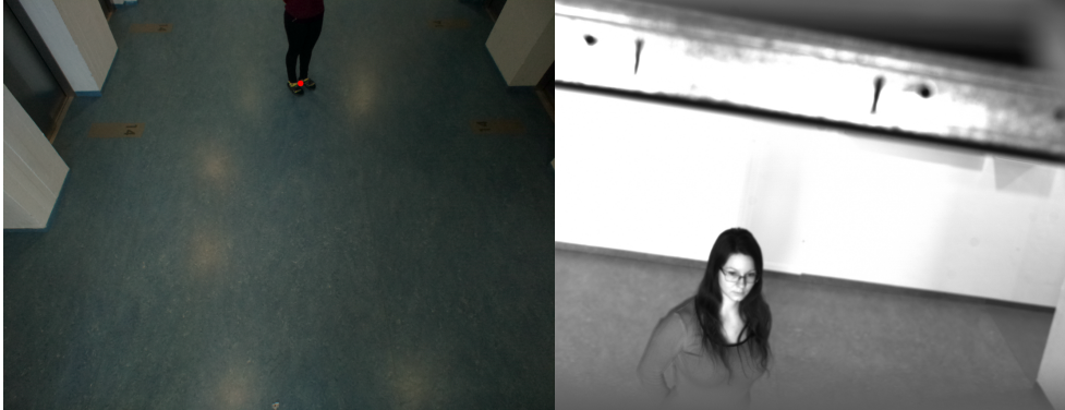
Obrázek 5.17: Měření 1: Vlevo snímek z přehledové kamery s vyznačením bodu zacílení, kdy není vidět horní část postavy. Vpravo zaměřená horní část postavy.
