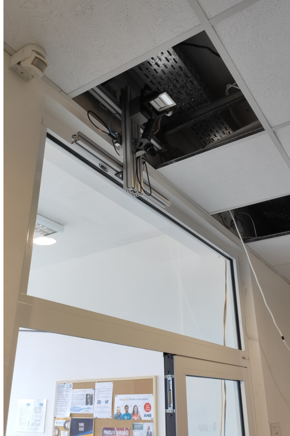
Obrázek 5.14: Testovací sestava umístěna u stropu pro snímání v nenulové výšce
