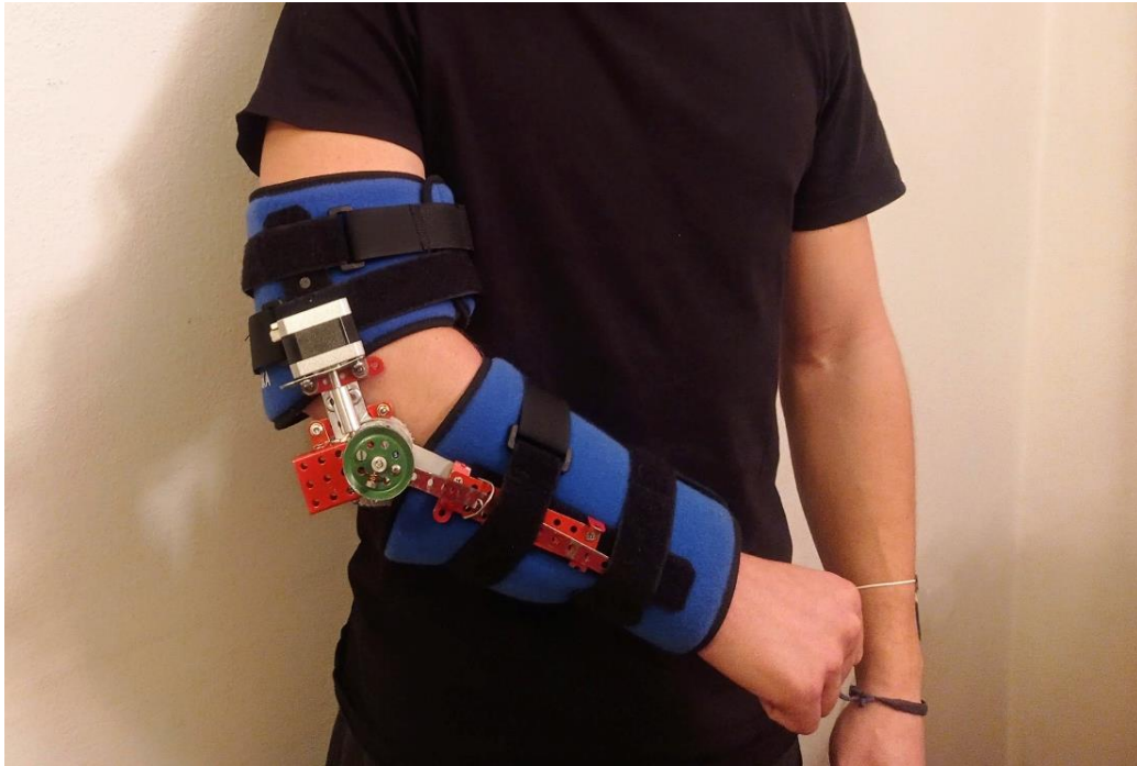
Obr. 12 – Výsledná podoba funkčního vzorku motorizované rehabilitační dlahy loketního kloubu
