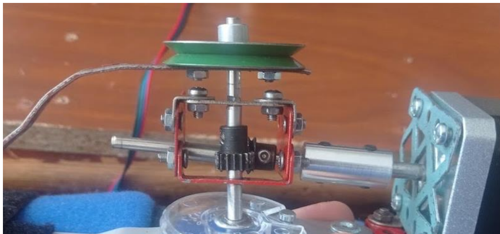
Obr. 15 – Nová obálka převodu, disponující 3 distančními vložkami uvnitř
