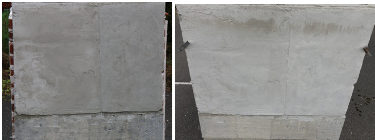
Obrázek 52: Pohled na nanášenou omítku stav v září 2015 – vlevo, stav v srpnu 2020 – vpravo.
