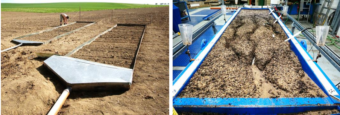
Obrázek 6 Ukázka experimentální erozní plochy s využitím neporušeného vzorku v terénu na experimentálním povodí Býkovického potoka (snímek vlevo) a porušeného půdního vzorku při měření pomocí laboratorního dešťového simulátoru ČVUT v Praze (snímek vpravo).
