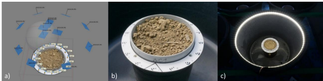
Obrázek 18 Půdní vzorek v SC při fotogrammetrickém měření: a) pozice fotoaparátu při snímání vzorku, b) půdní vzorek v SC s referenčními terči, c) SC se sběrnou nádobou vybavenou kruhovým LED osvětlením.
