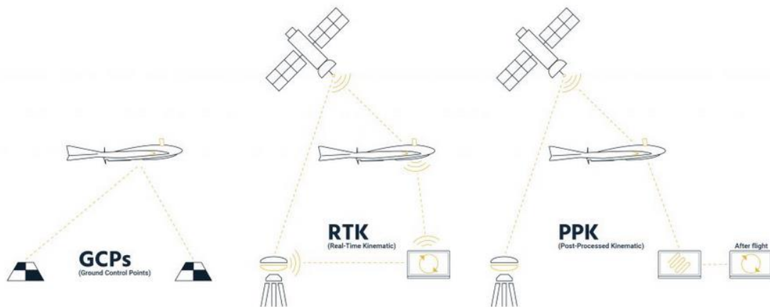
Obrázek 15 Schématické znázornění různých způsobů georeferencování dat získaných pomocí UAV: GCP - metoda využívající referenční zaměřené vlíčovací body (nejběžnější způsob i u pozemní fotogrammetrii) a metody RTK a PPK využitelné pro UAV fotogrammetrii (převzato od Blake, 2020).
