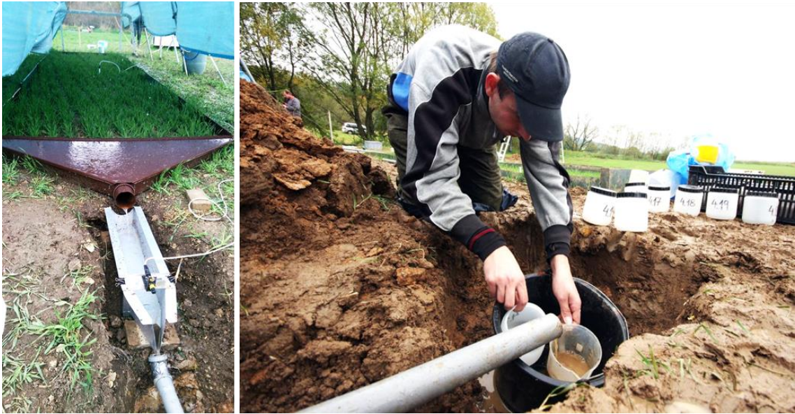
Obrázek 4 Měření povrchového odtoku pomocí ultrazvukového čidla ve žlabu (snímek vlevo) a pomocí manuálního odběru povrchového odtoku s měřením času (snímek vpravo).
