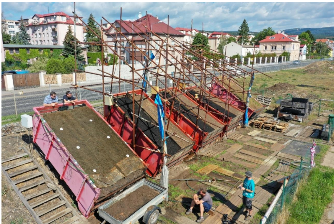
Obrázek 11 Venkovní stabilní dešťový simulátor tryskového typu na experimentální lokalitě společnosti Strix v Jirkově.
