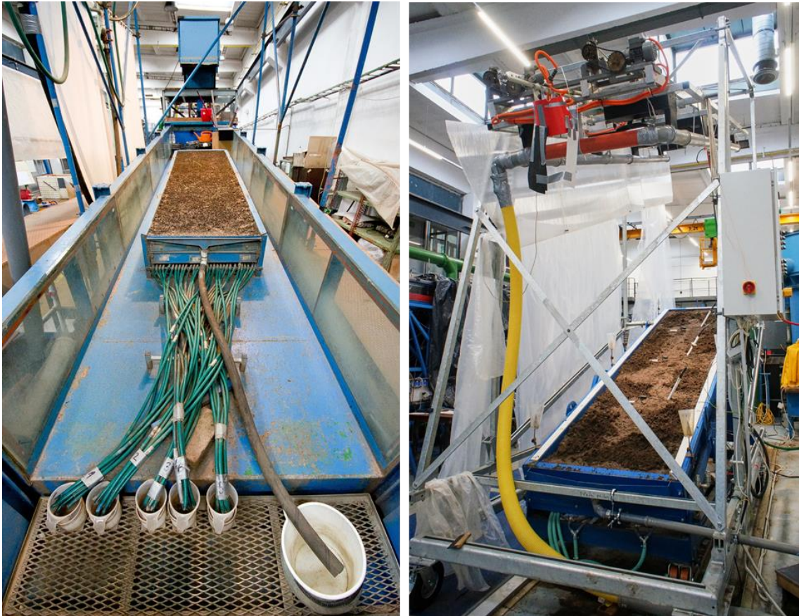
Obrázek 9 Srovnání laboratorního DS ČVUT v Praze před rekonstrukcí na hydraulicky sklopném žlabu s maximálním sklonem do 10° (snímek vlevo) a celkově rekonstruovaným DS se samostatně sklopným erozním žlabem s maximálním sklonem do 40° (snímek vpravo)
