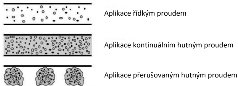
Obrázek 3.8: Možné proudy nástřiku aplikace mokré směsi stříkaného betonu, Girmscheid, 2000
