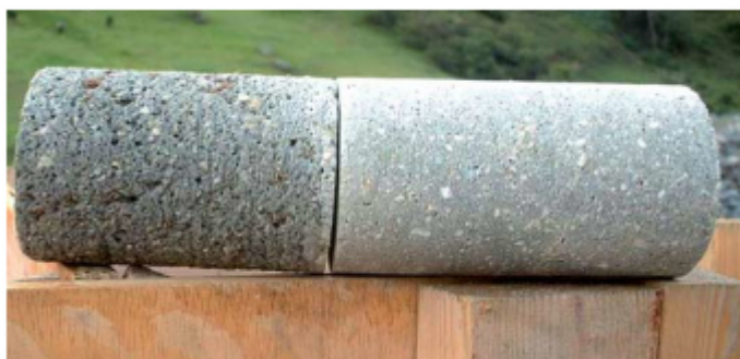
Obrázek 3.14: Vliv způsobu nástřiku na kvalitu ostění, Hilar a kol., 2008
