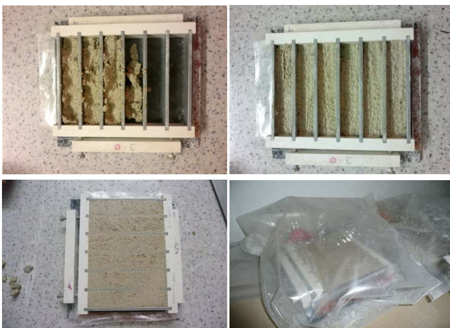
Obr. 20: Postup výroby maltových zkušebních tělísek
