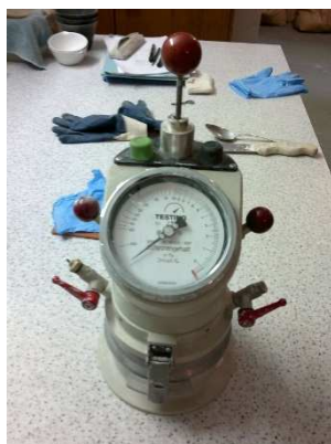
Obr. 31: Přístroj Air Entrainment Meter typ TESTING s ruční pumpičkou
