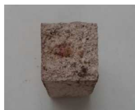
Obr. 21: Karbonatace maltového vzorku R1
