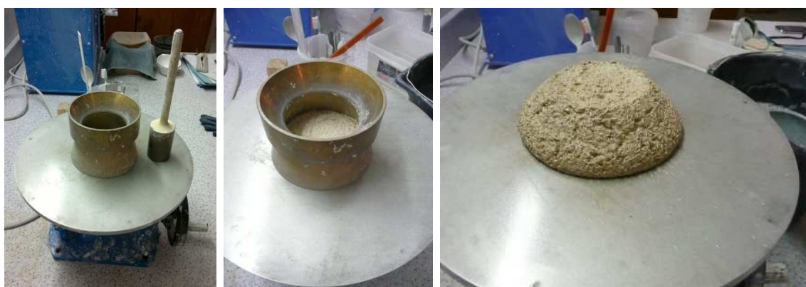
Obr. 30: Fotografie z postupu zkoušky konzistence čerstvé malty
