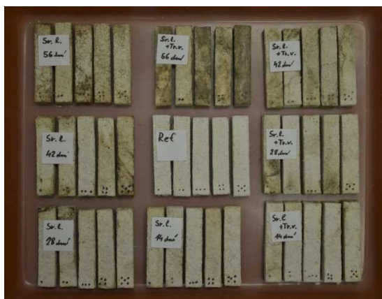
Obr. 22: Maltové trámečky po vystavení působení dřevomorky domácí
