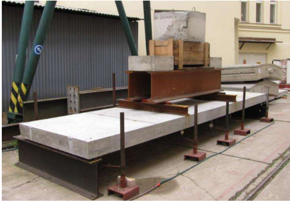
Obr. 3.15 Fotografie z průběhu ohybové zkoušky (12.12.2013, Kloknerův ústav ČVUT), převzato z [1]
