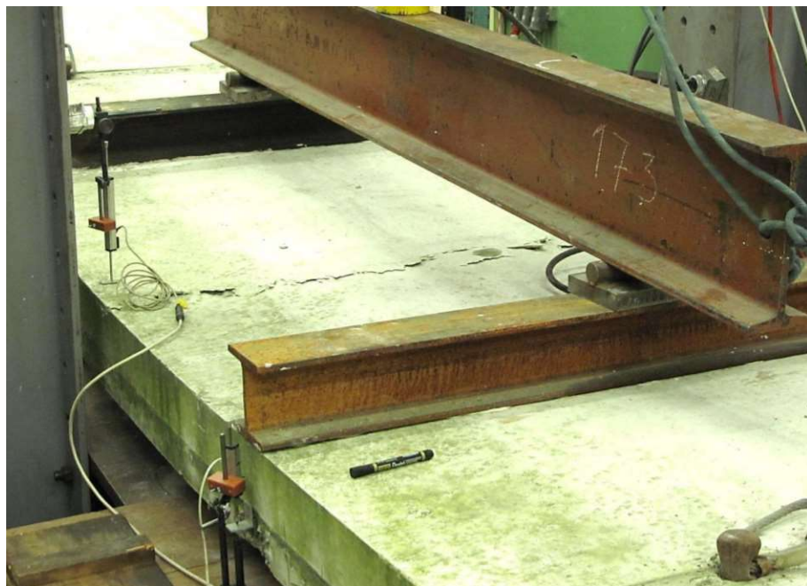
Obr. 3.7 Drcení betonu u horního povrchu panelu při dosažení únosnosti, převzato z [1]
