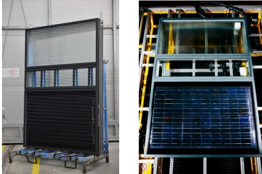
Obr. 4.7 Energeticky aktivní fasádní modul LOP s integrovaným FVT kolektorem (vlevo) a fasádní modul s integrovaným FVT kolektorem umístěným na solárním simulátoru (vpravo)
