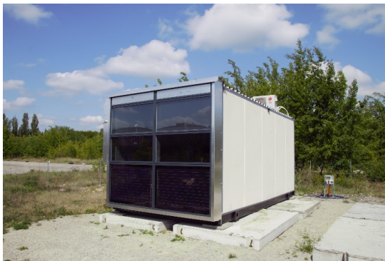
Obr. 5.8 Experimentální buňka pro testování energeticky aktivních fasád
