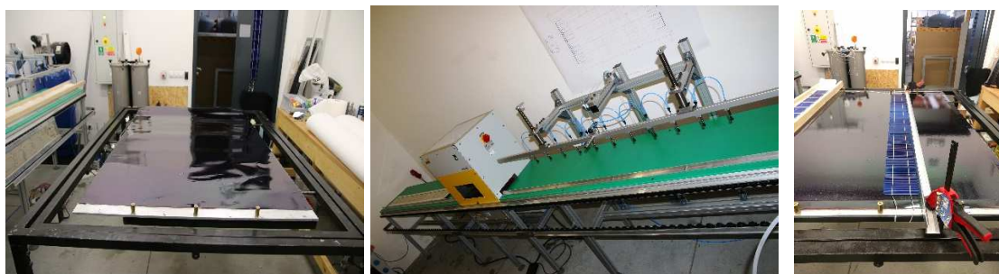
Obr. 4.3 Měděný plech s PVC folií (vlevo), FV stringer (uprostřed), pokládání FV stringů (vpravo)
