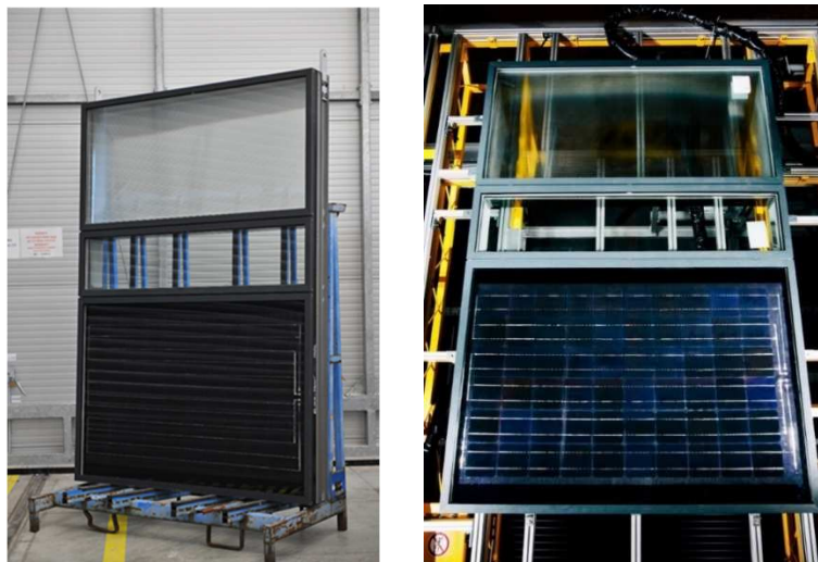
Obr. 4.9 Energeticky aktivní fasádní modul LOP s integrovaným FVT kolektorem (vlevo) a fasádní modul s integrovaným FVT kolektorem umístěným na solárním simulátoru (vpravo)
