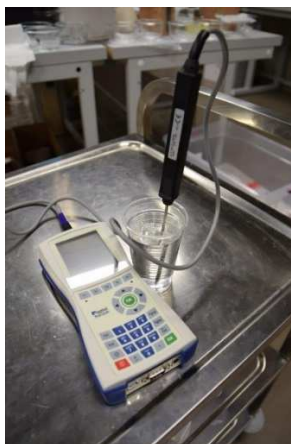
Obr. 4.25 Měření tepelné vodivosti polysiloxanového gelu
