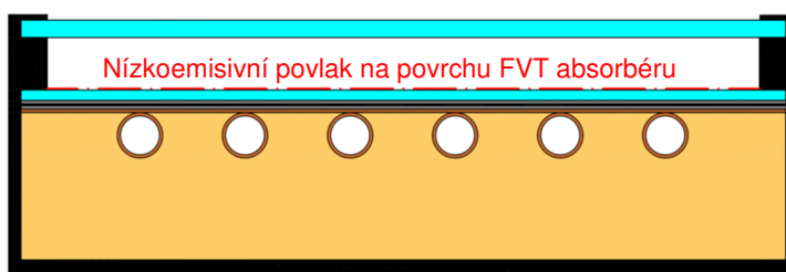
Obr. 4.19 FVT kolektor s vyznačeným (čerchovaně červeně) nízkoemisivním povrchem na horním povrchu FVT absorbéru
