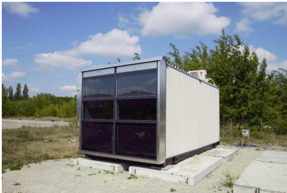
Obr. 5.10 Experimentální buňka pro testování energeticky aktivních fasád
