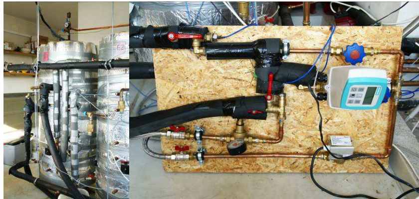
Obr. 5.9 Zapojení pro emulaci odběru teplé vody
