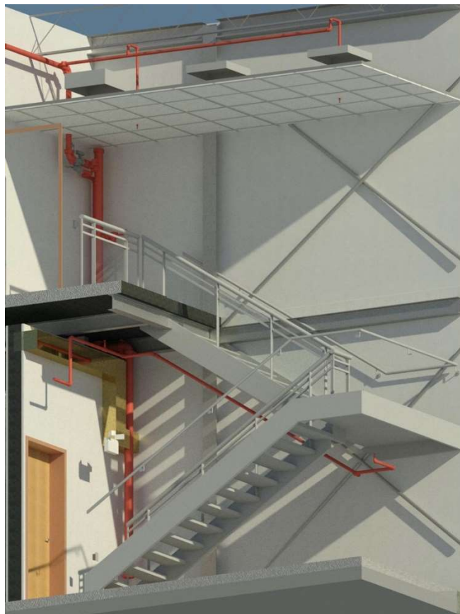
Obr. 24 Řez BIM modelem SHZ [36]
