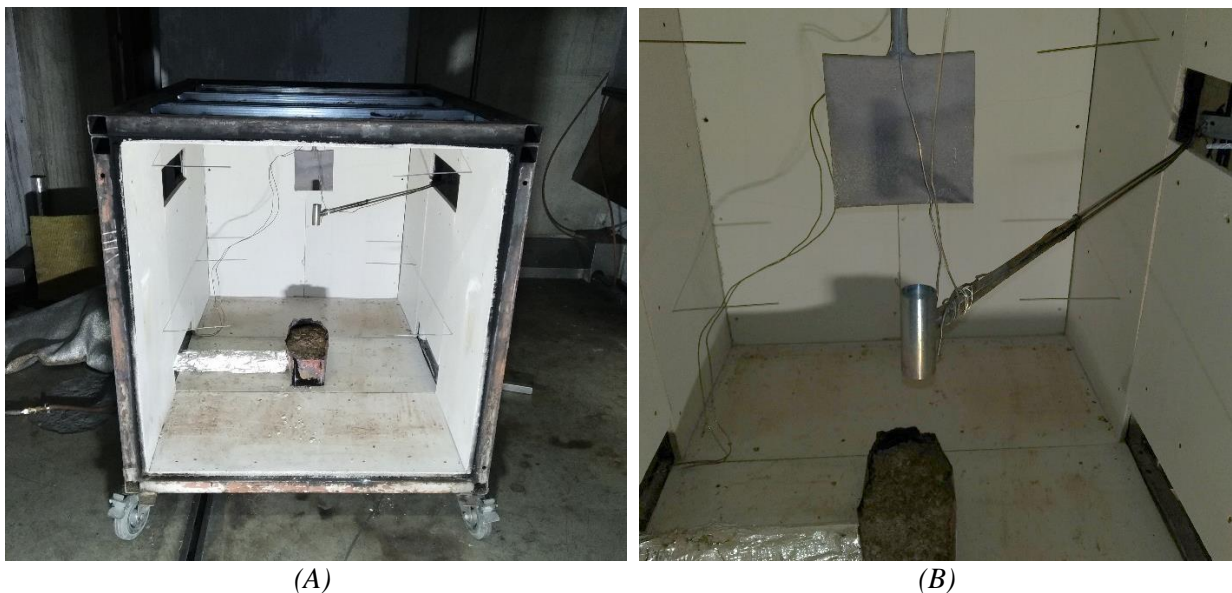
Obr. 54: Zkušební pec – experiment 2: (A) pohled na vnitřek pece; (B) rychlostní sonda umístěná ve vnitřku zkušební pece
