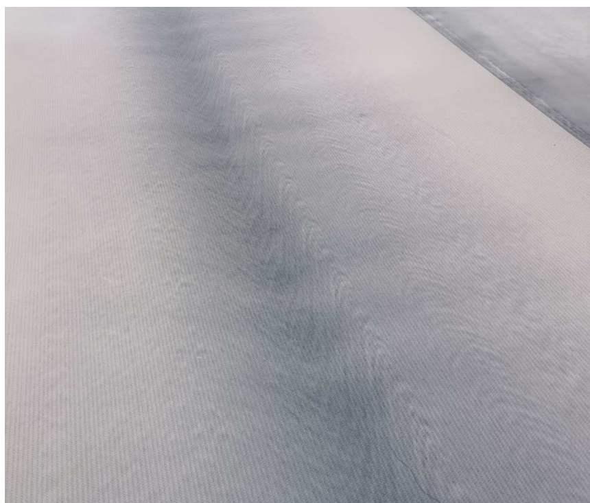
Obrázek 19, Detail pnutí vnitřní výztužné vložky
