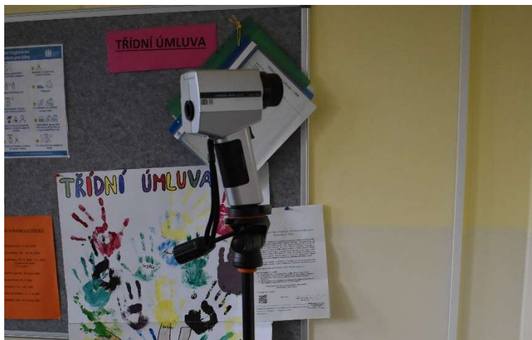
Obr. 37 - Digitální jasoměr použitý při měření jasu v učebnách
