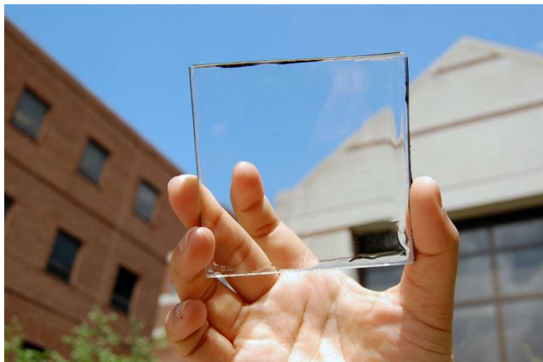
Obr. 7 - Fotovoltaické články aplikované na sklo (27)
