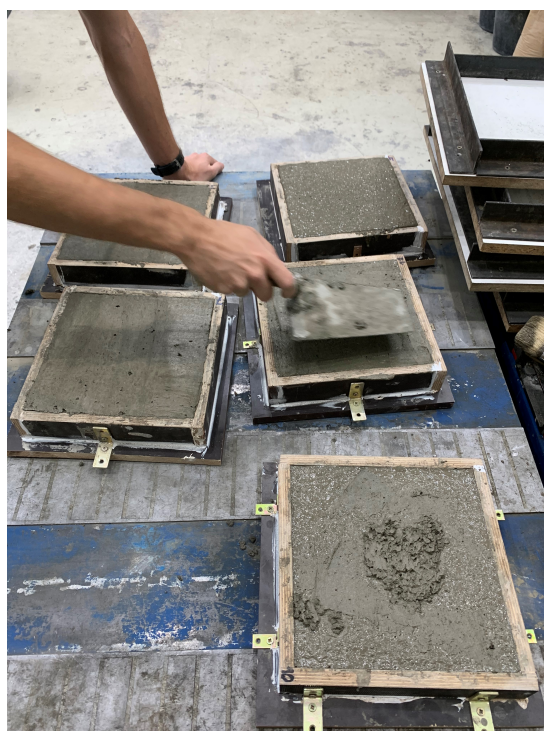
Obrázek 8.2: Vibrování betonové směsi ve formách v Experimentálním centru
