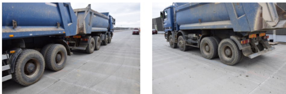
Obrázek 5.4: Zatěžovací zkouška s využitím dvou těžkých nákladních vozidel
