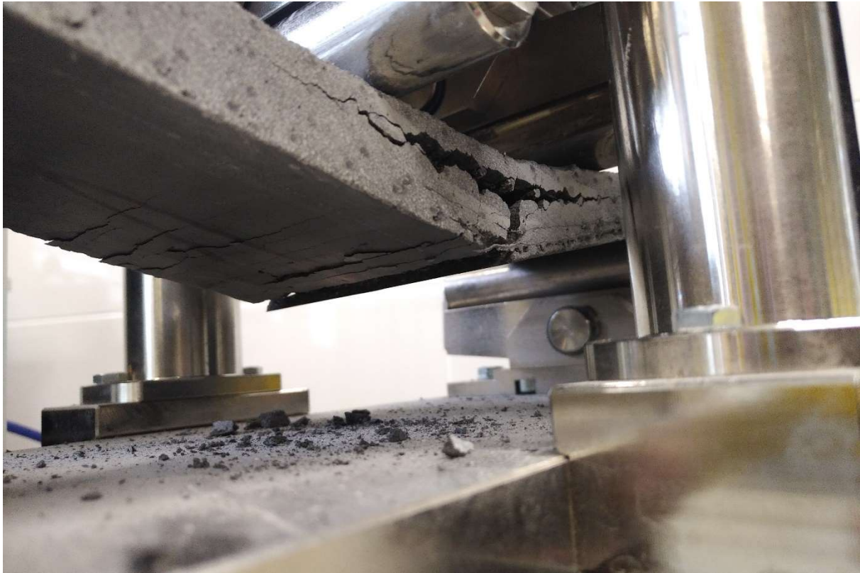
Obrázek 27: Značná trhlina vzorku s impregnovanou textilií, pracovní diagram tohoto vzorku je na obrázku 26
