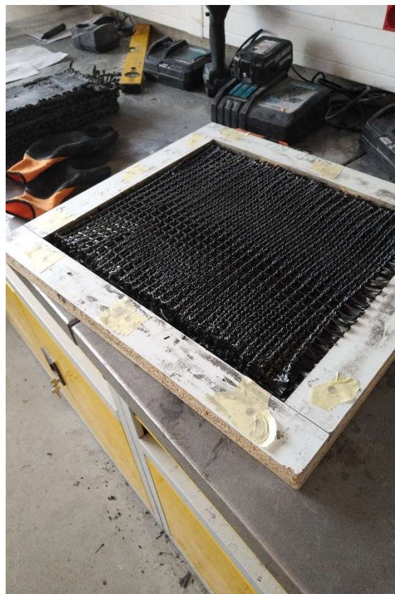
Obrázek 14: Výztuž záměrně menší než bednění z důvodu zachytávání betonu na okrajích bednění
