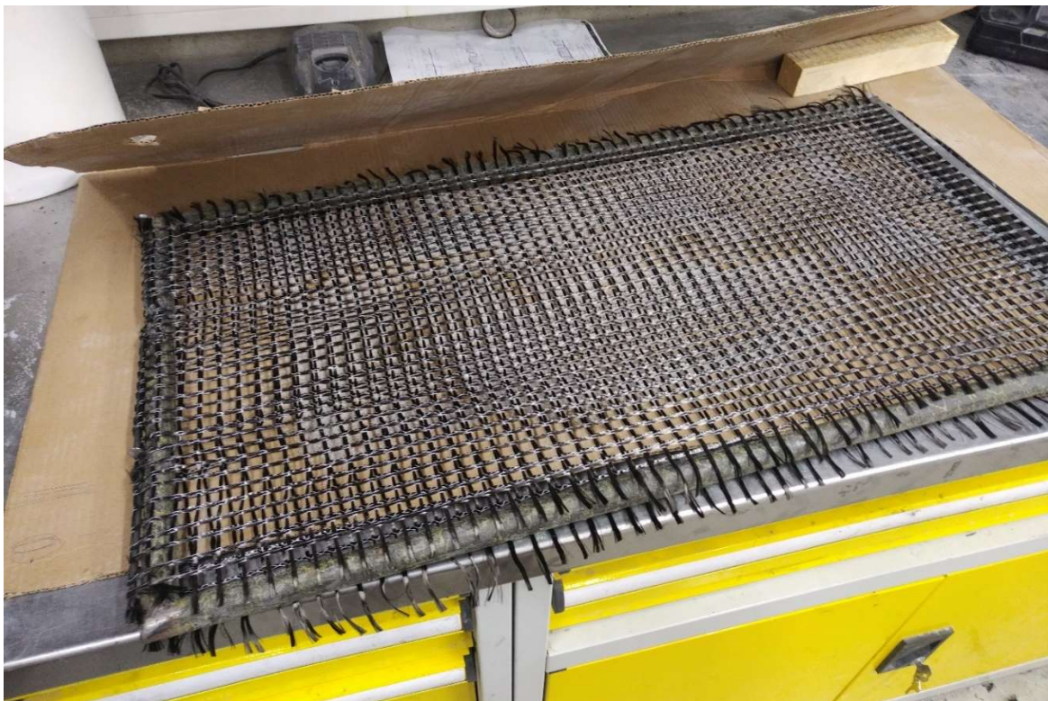
Obrázek 15: Impregnace karbonové textilie pryskyřicí a popískování
