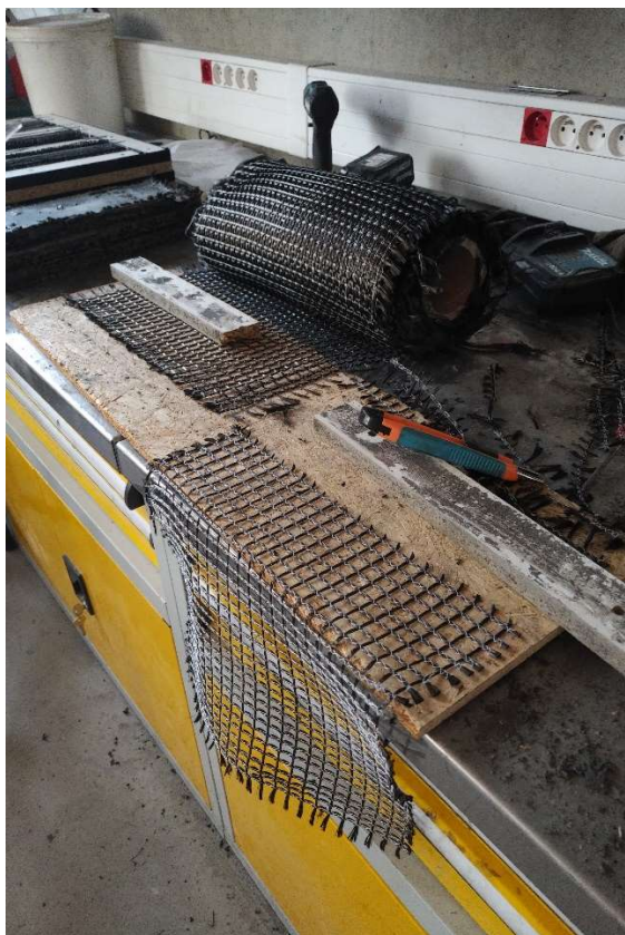
Obrázek 13: Poddajná neimpregnovaná karbonová textilie
