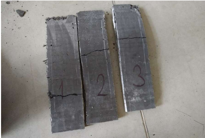
Obrázek 37: Pohled na trhliny vzorků 3K_LS
