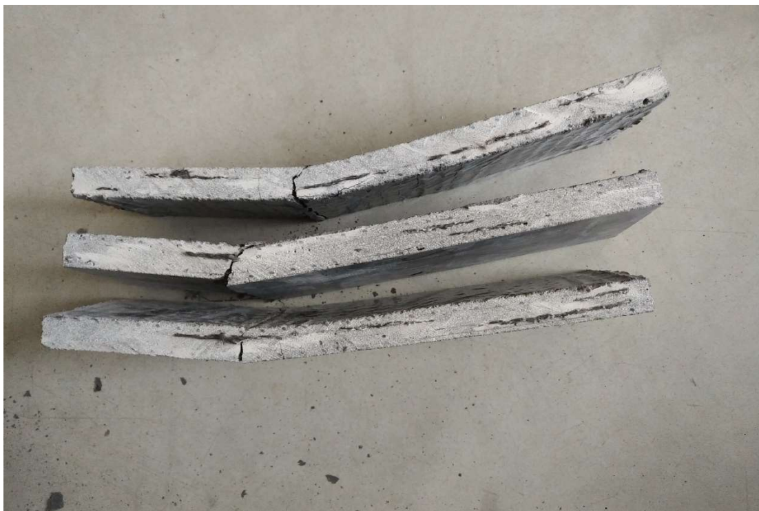
Obrázek 36: Zřetelná trhlina způsobená ohybem v kombinaci se smykovou silou (vzorky 4K_LS)
