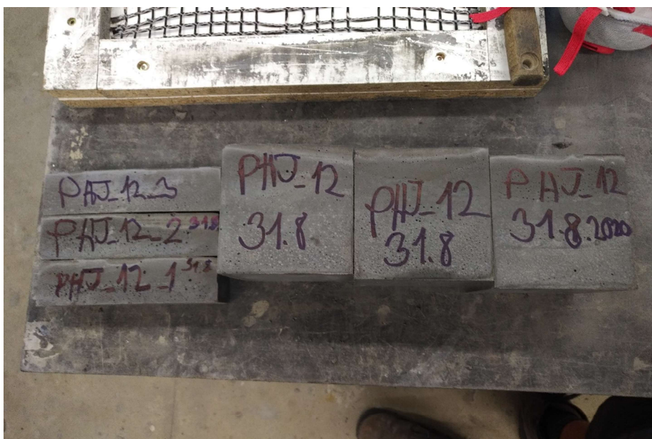
Obrázek 7: Zmenšení pórovitosti vzorků změnou plastifikátoru u poslední varianty receptury, vzorky PHJ_12
