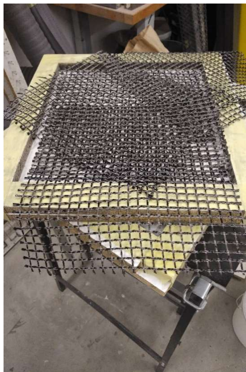
Obrázek 1: Karbonová síť (bez prosycení) pro vyztužení betonu, plošná hmotnost 255 g/m 2
