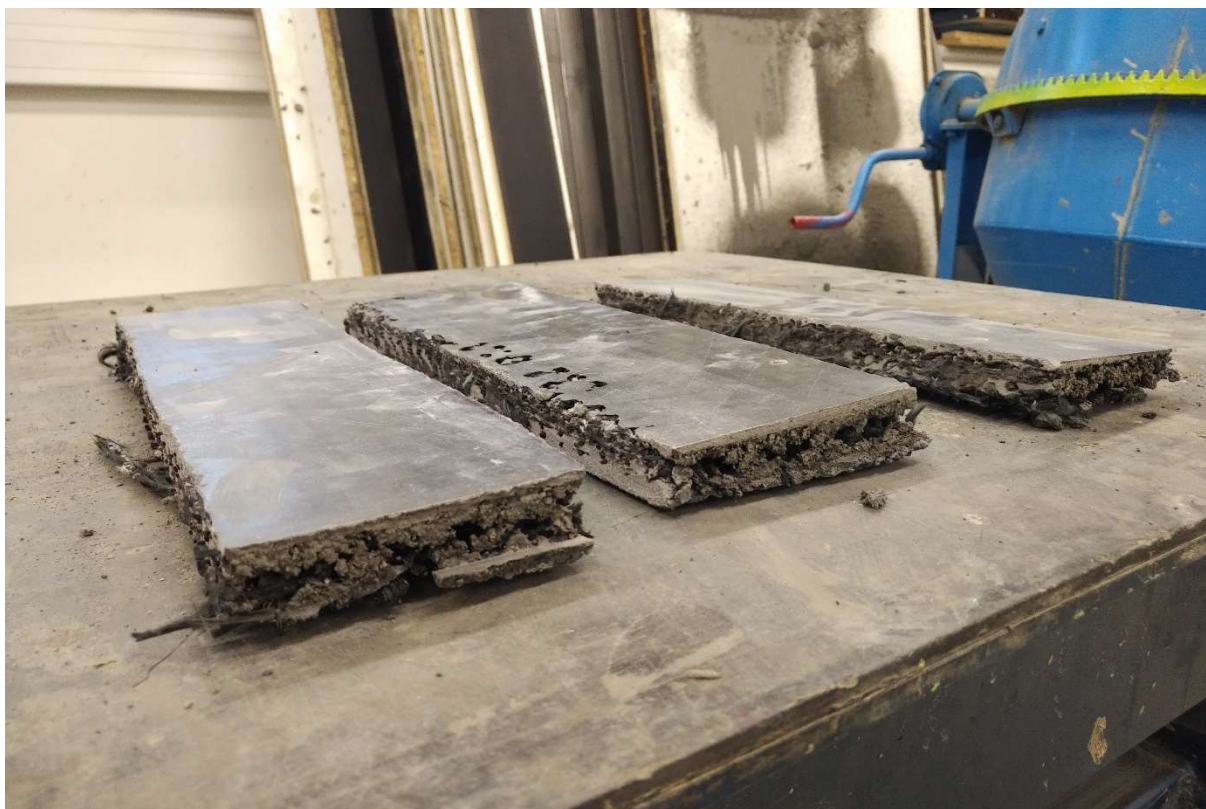
Obrázek 19: Stále značné dutiny ve vzorcích ze třetí sady
