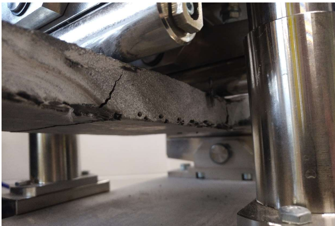
Obrázek 25: Charakteristické trhliny na vzorku s neimpregnovanou textilií pod zatěžovacími podporami, pracovní diagram tohoto vzorku je na obrázku 24
