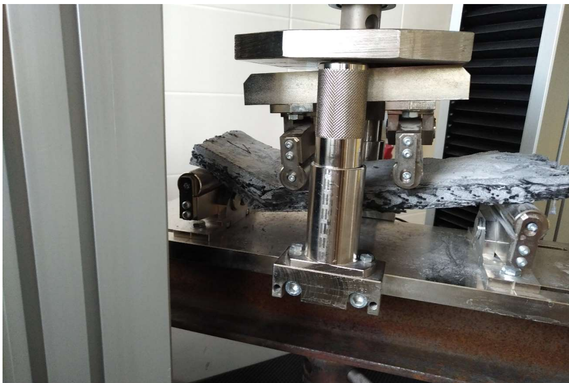
Obrázek 23: Pohled na zařízení pro zkoušku čtyřbodovým ohybem, zde na konci zkoušky
