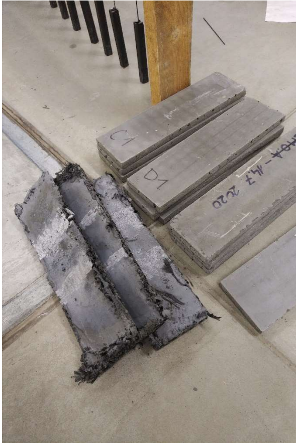
Obrázek 17: První sada stříkaných vzorků – 3 vzorky vlevo. Napravo od nich se nachází litá varianta z jiné práce
