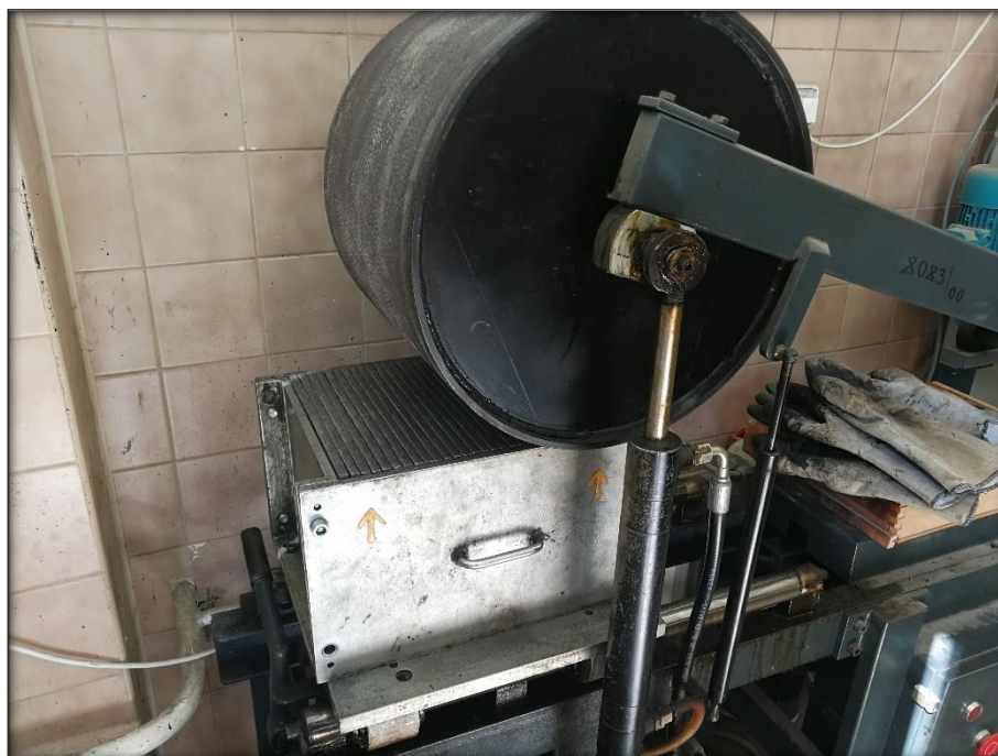
Obrázek 28: Výroba desek pomocí ocelového válce
