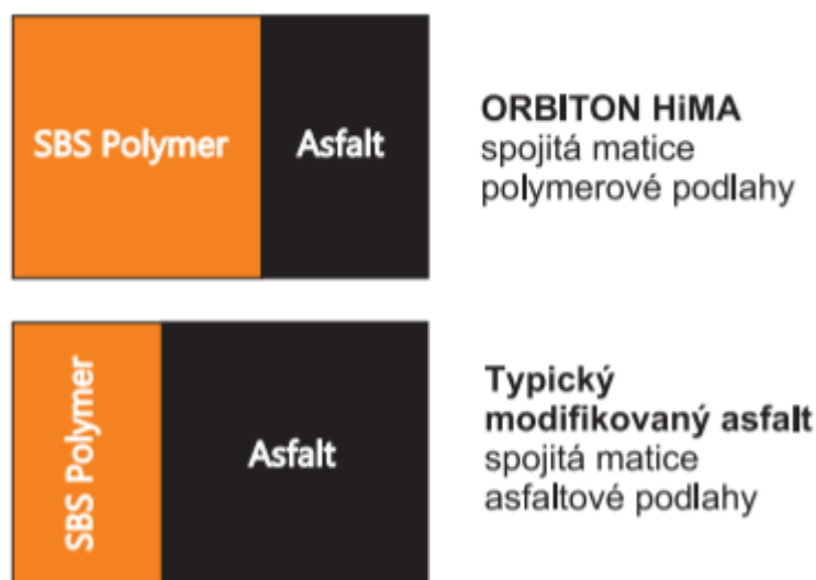
Obrázek 8: Poměr objemové fáze SBS polymeru a asfaltu [25]
