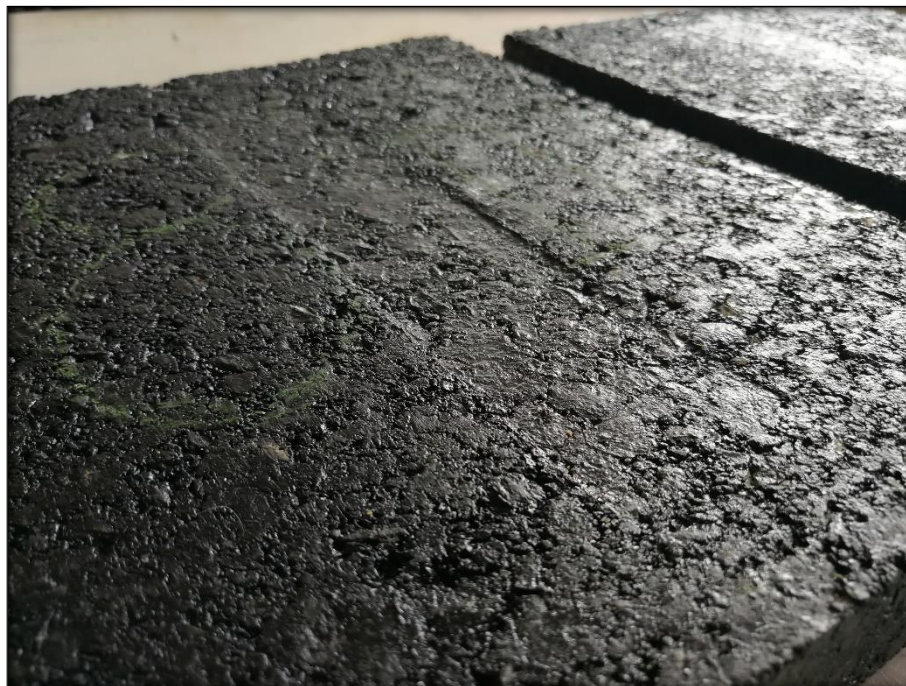
Obrázek 36: Vyjetá kolej v desce
