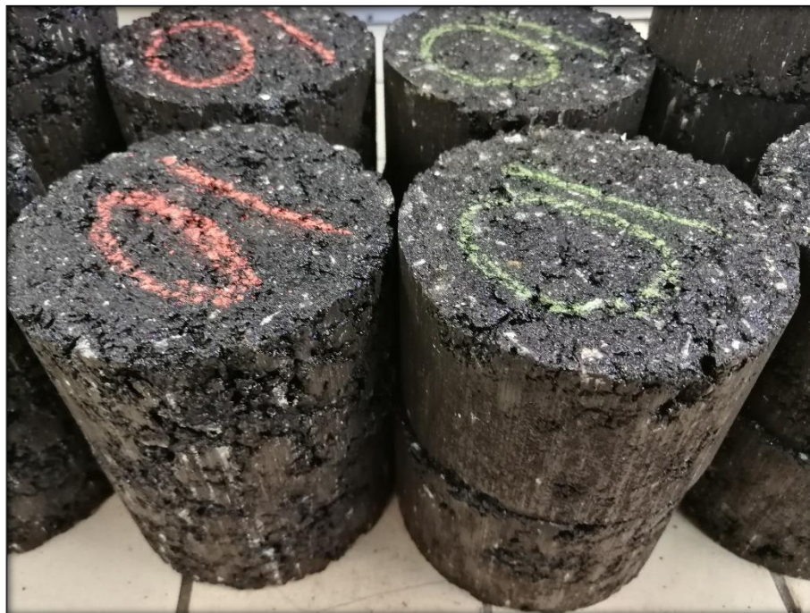
Obrázek 30: Tělesa zhutněná 2 x 25 údery (vlevo) a 2 x 75 údery (vpravo)
