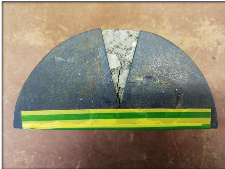
Obrázek 41: Trhlina na půlválcovém tělese
