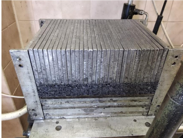
Obrázek 11 - Výroba zkušebních těles pro zkoušku pojíždění kolem
