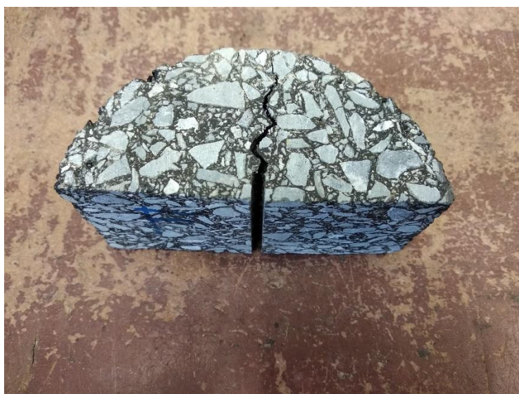
Obrázek 24 – Zkušební těleso po zkoušce odolnosti vůči šíření mrazové trhliny
