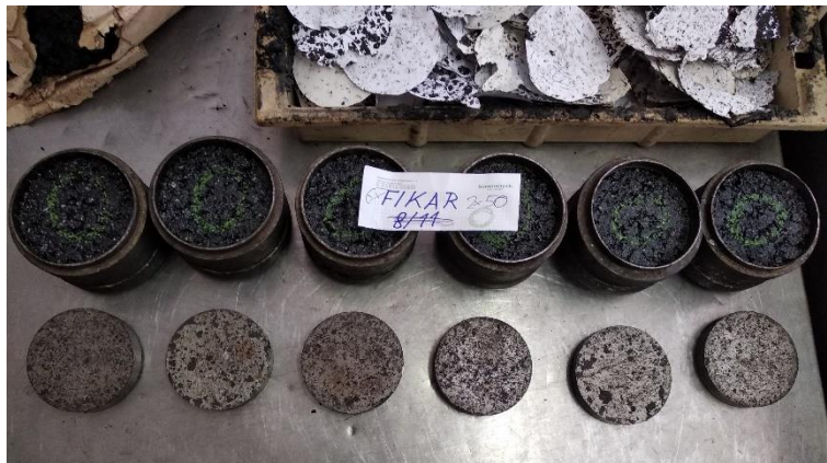
Obrázek 10 – Výroba zkušebních těles rázovým zhutňovačem
