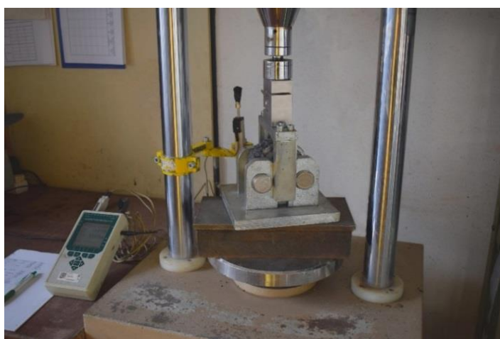
Obrázek 23 – Průběh zkoušky odolnosti vůči šíření mrazové trhliny
