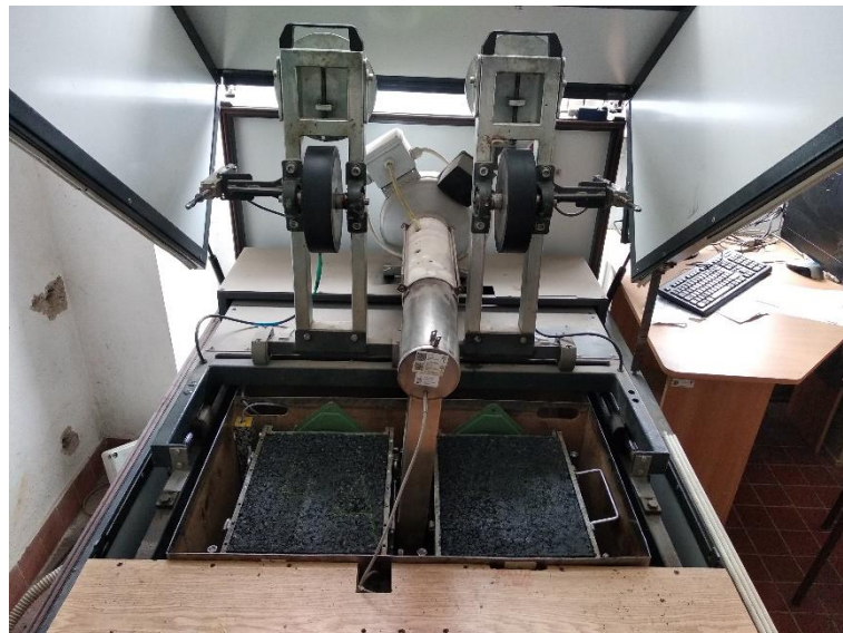
Obrázek 16 – Zkouška poježdění kolem
