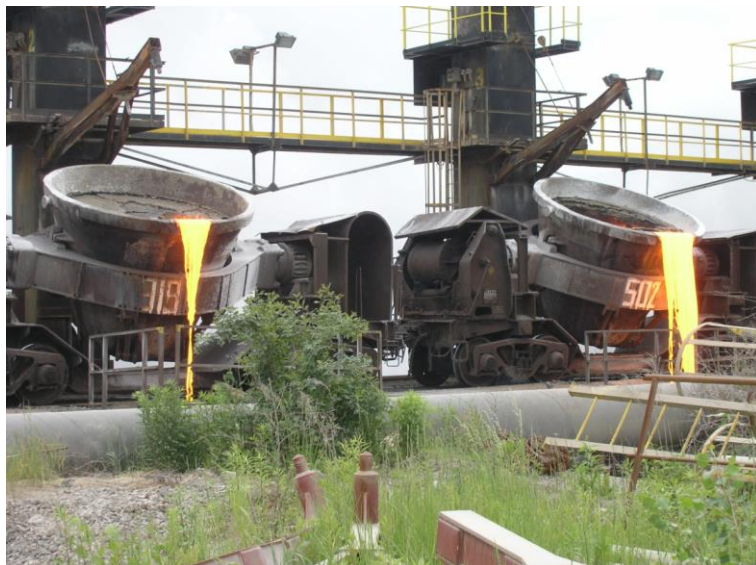
Obrázek 6 – Vylévání žhavé strusky z železničních vozů [2]
