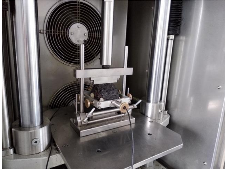
Obrázek 20 – Měření tuhosti válcového zkušebního tělesa v příčném tahu
