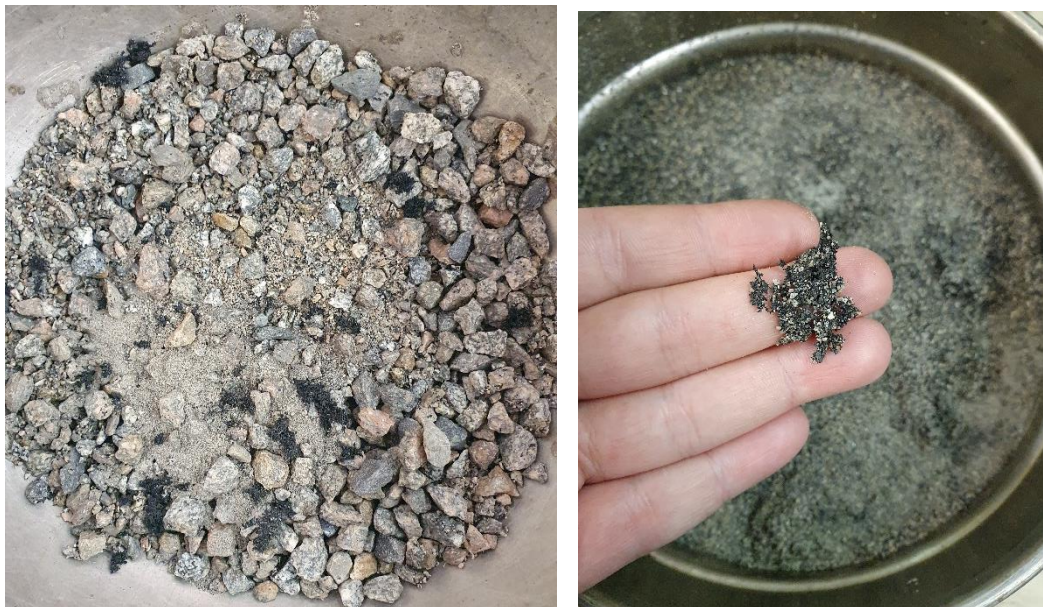
Obr. 18 – Směs kameniva a částice pryže po extrakci pojiva [12]
