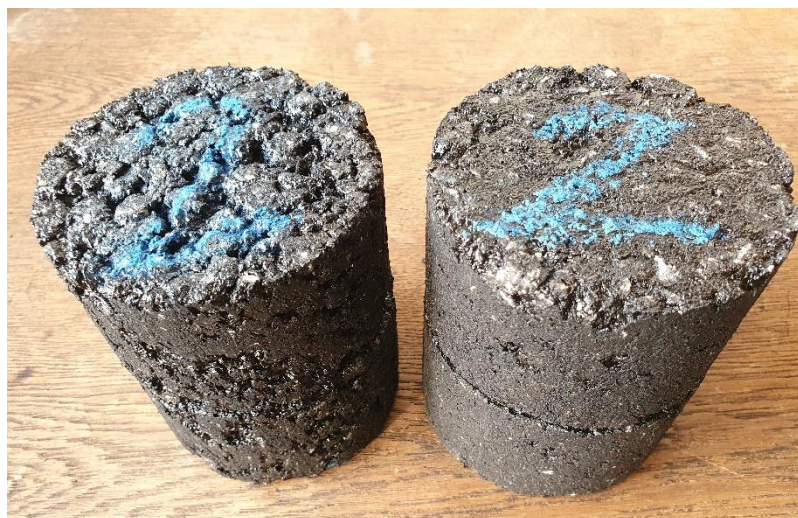
Obr. 16 – Válcová tělesa hutněna 2x25 úderů (vlevo) a 2x75 úderů (vpravo) [12]
