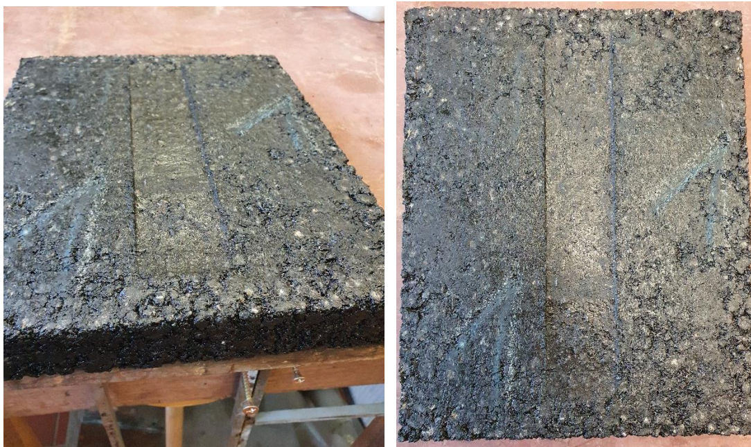
Obr. 25 – Deska po zkoušce poježdění kolem – viditelná vyjetá kolej
