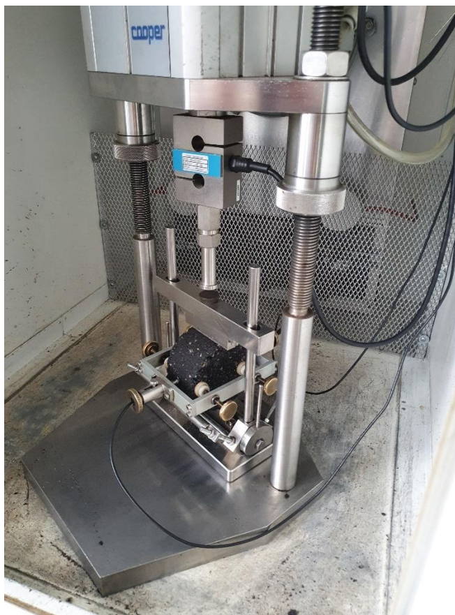
Obr. 19 – Těleso upevněné v rámečku – zkouška IT-CY [12]
