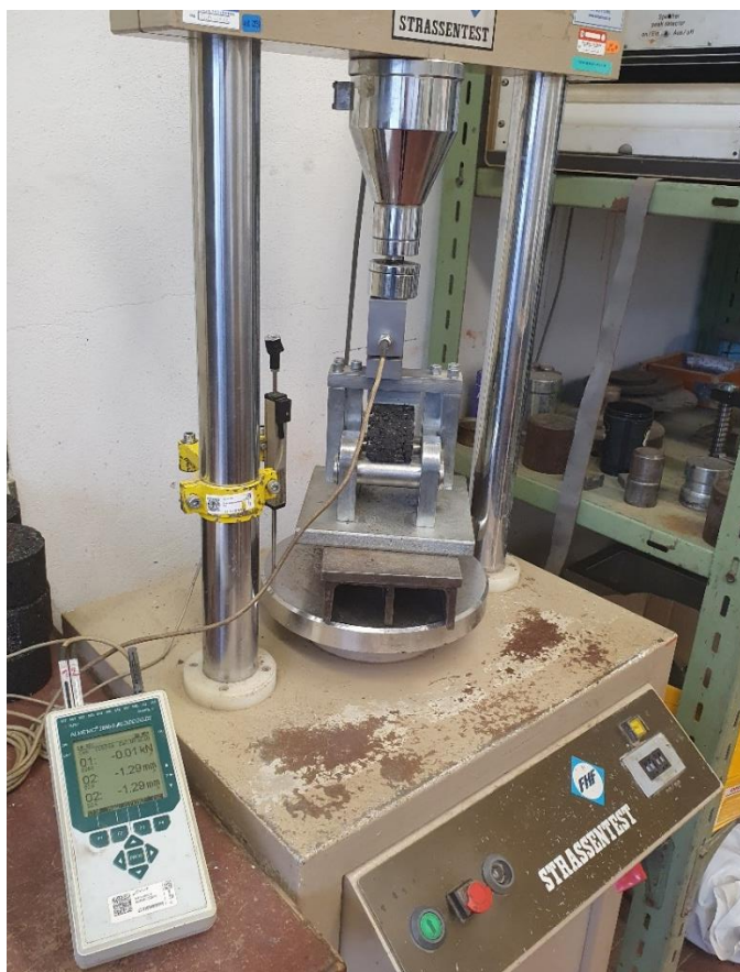
Obr. 20 – Zatěžování půlválcového zkušebního tělesa [12]
