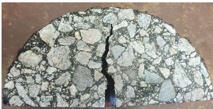
Obr. 22 – Zkušební těleso po SCB testu [12]
