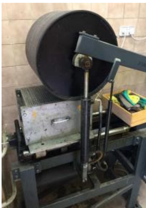
Obr. 17 – Lamelový zhutňovač – výroba desek
