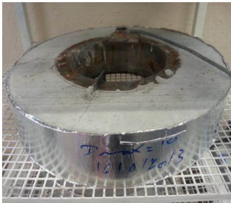
Obrázek 12: Experimentální vzorek zapečetěný po vnějším obvodě proti vysychání [18].
