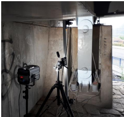
Obr. 46 Sestava pro měření deformací metodou DIC (foto: Vojtěch Stančík)
