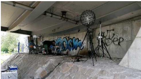
Obr. 70 Pohled na akustickou kameru pod mostem [13]
