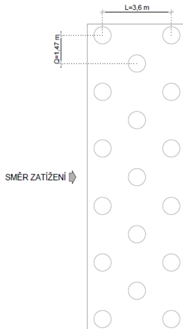
Obr. 103 Podpěra P3 – schéma geometrie pilot, směr zatížení X
