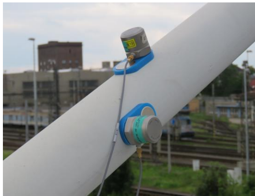
Obr. 60 Pohled na absolutní snímače zrychlení (foto: Michal Polák)
