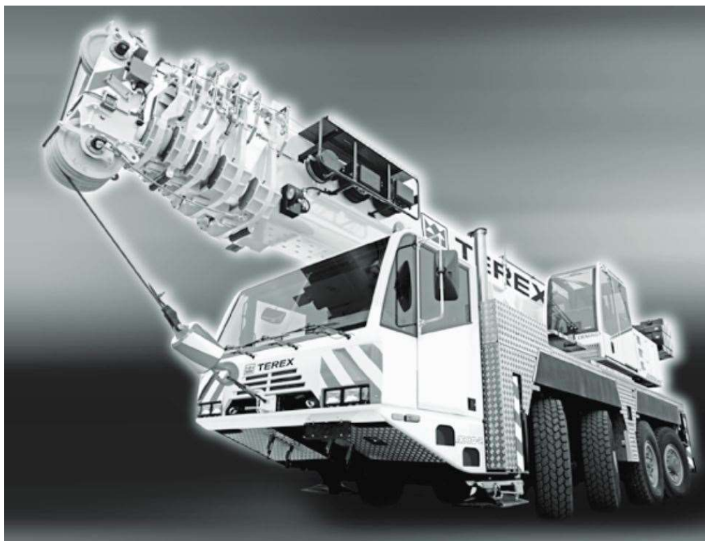
Obrázek 6 - autojeřáb TEREX DEMAG AC 80-2 Zdroj: https://www.jeraby-autojeraby.cz
