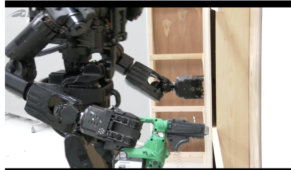
Obrázek 22: HRP-5P připevňující překližkovou desku [28]
