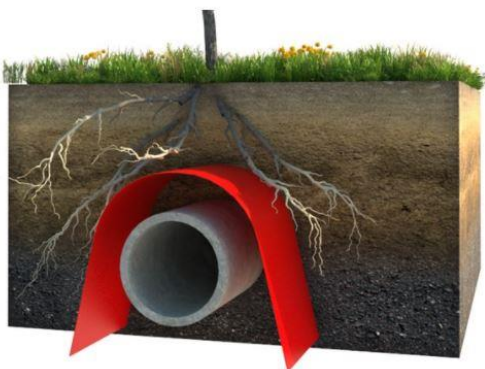
Obr. 11: Instalace bariéry kolem VTV (46)
