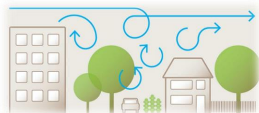
Obr. 1: Směšování a proudění vzduchu vlivem stromů a různé výškové variability budov (2)
