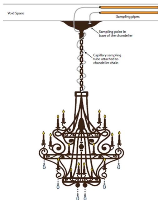
Obr. 22 Vzorkovací potrubí u lustru [2]
