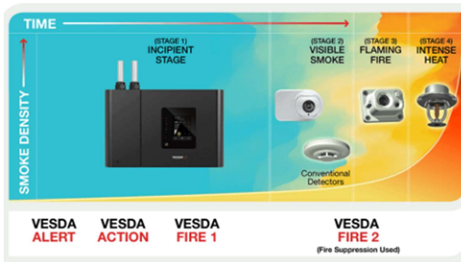
Obr. 10 Průběh požáru a reakce detektorů [7]
