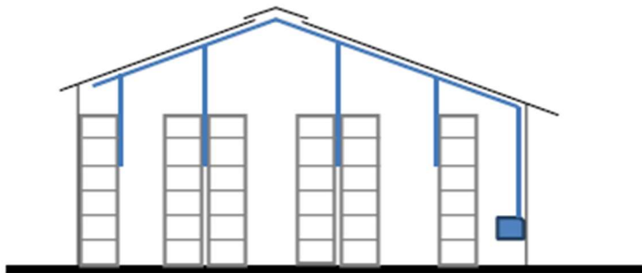
Obr. 19 Sestup vzorkovacího potrubí ze stropní úrovně [2]
