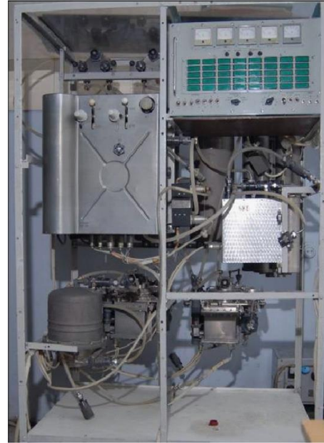
Obr. 26: Systém regenerace vody z moči (vlevo) a systém regenerace vody z kondenzátu vlhkosti na kosmické stanici Mir (vpravo) [24]
