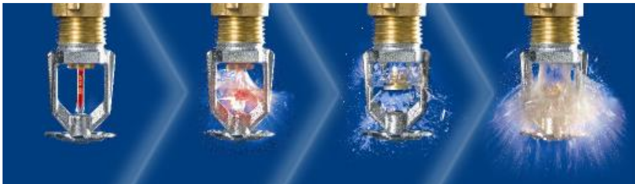
obr. 10: Otevření sprinkleru po dosažení otevírací teploty skleněné pojistky [14]
