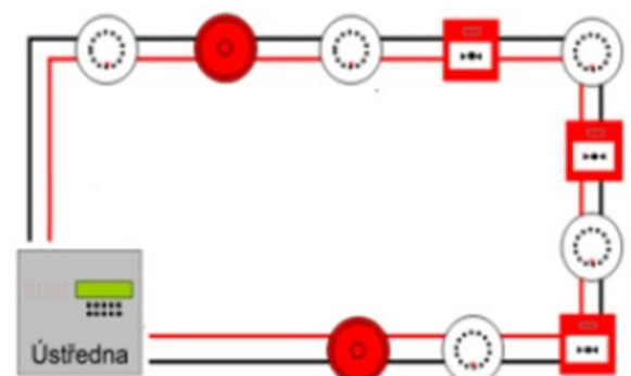
Obrázek 5: schéma okružní sítě EPS [8]
