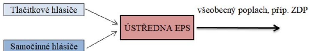
Obrázek 8: schéma jednostupňového vyhlášení poplachu [10]
