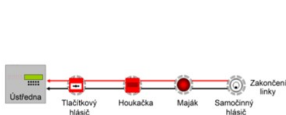
Obrázek 4: schéma liniové sítě EPS [8]
