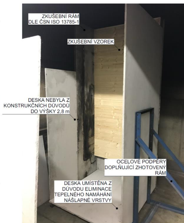
Obr. 21: Návrh a provedení požární zkoušky
