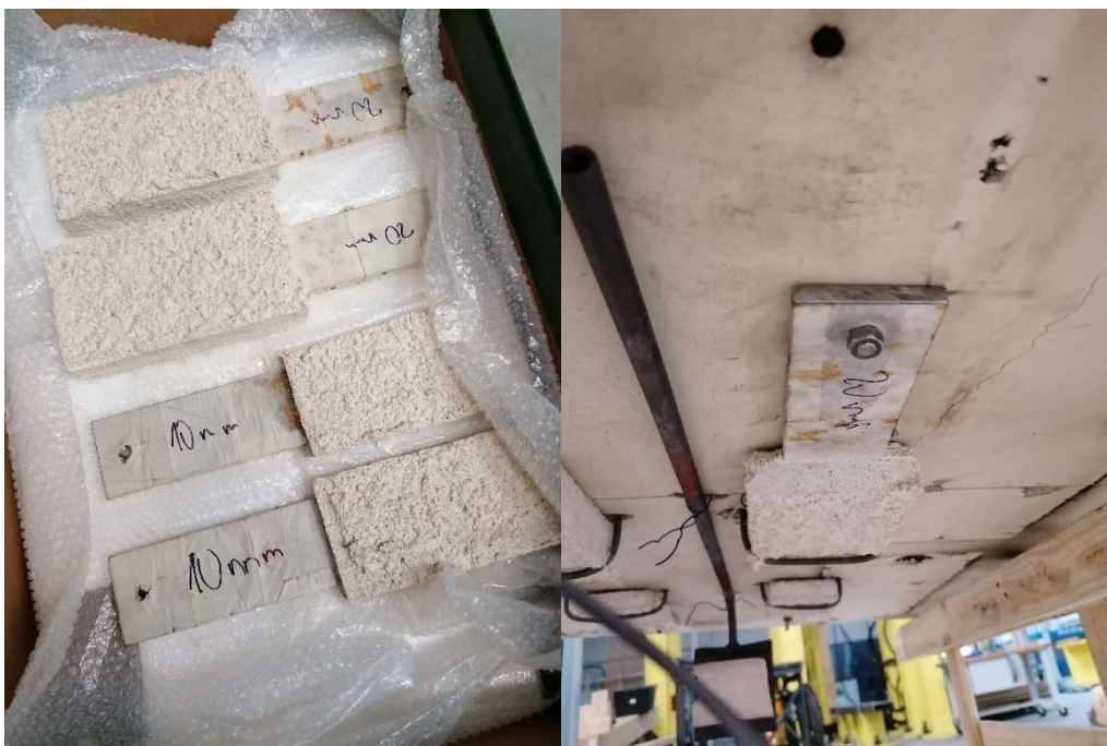
Obr. 48 (a) Zhotovené vzorky (b) Připevnění vzorku ke stropu pece
