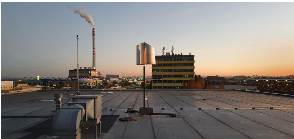
Obrázek 35, větrná turbína se svislou osou - měřicí stanice.
