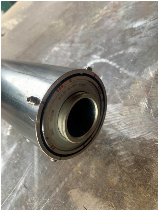
Obrázek 36, nosná kostra s ložisky pro osu turbíny.
