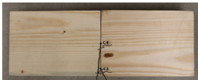
Obr. 25 Vzorek „C“ se zabudovanými termočlánky. Foto Lukáš Velebil
