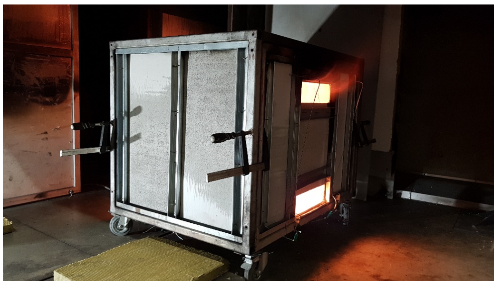
Obr. 16 Pohled na zkušební pec miniFUR během požární zkoušky. Foto Marek Pokorný
