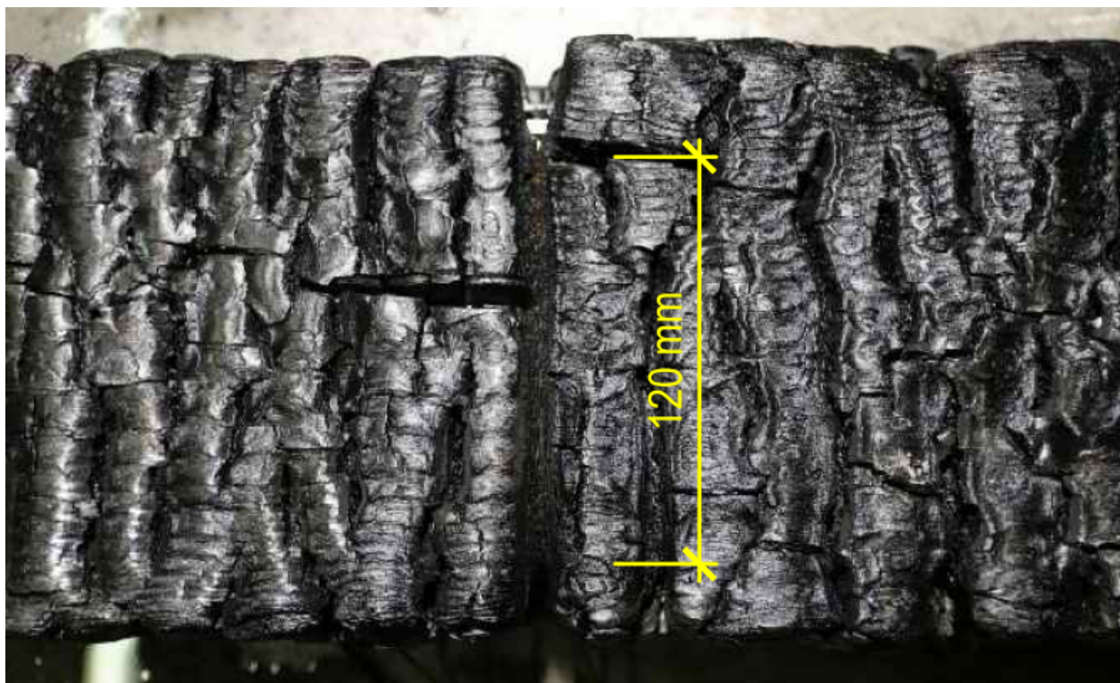
Obr. 38 Vzorek „A“ s vyznačeným zbytkovým průřezem. Foto Lukáš Velebil
