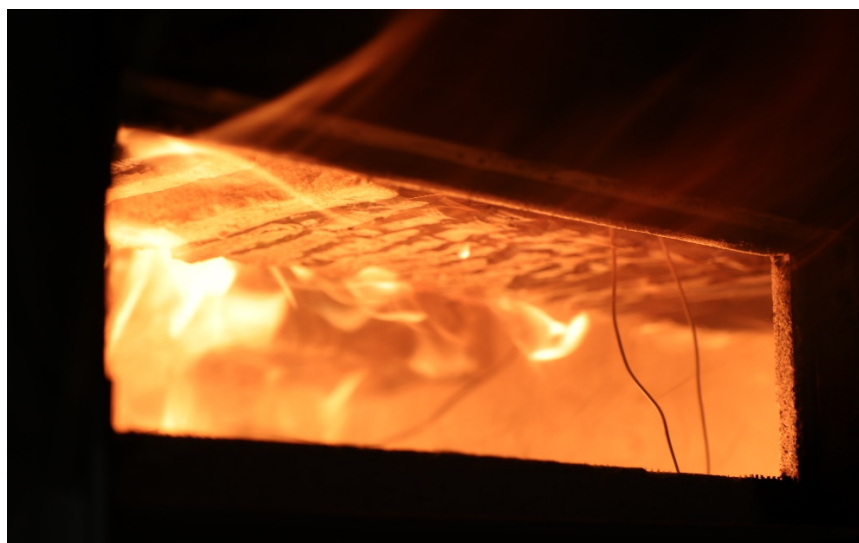
3 – 15. minuta požární zkoušky, pohled na vzorky. Foto Lukáš Velebil
