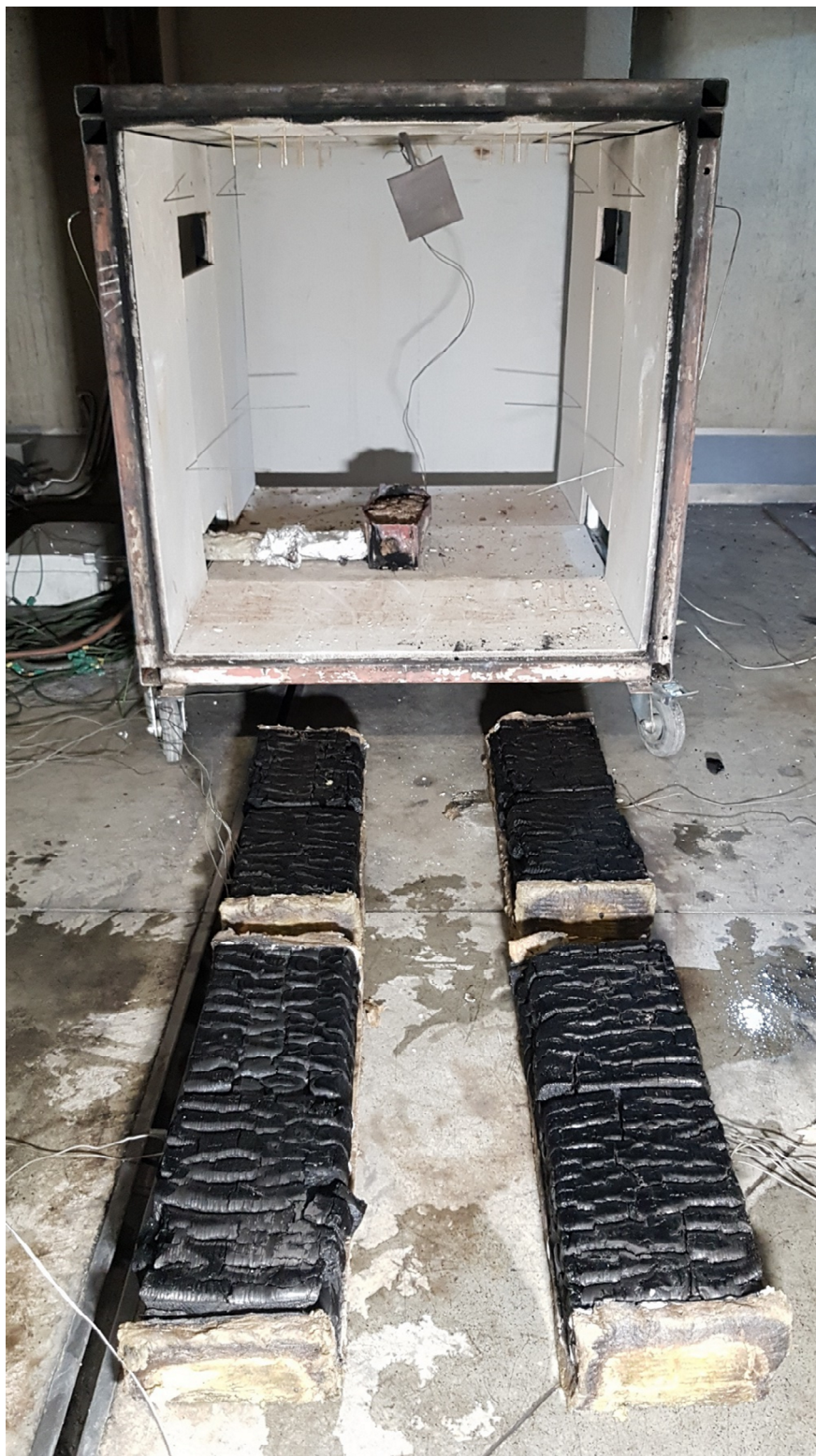
4 – Pohled na vzorky a zkušební pec miniFUR po provedené 30minutové zkoušce. Foto Marek Pokorný
