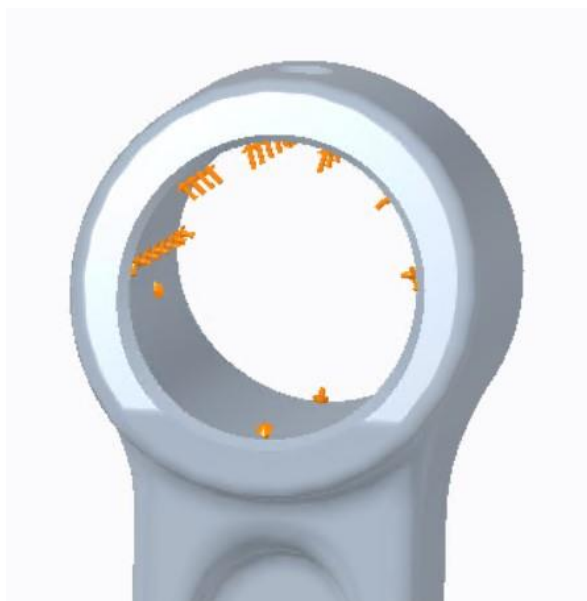
Obrázek 75 - Detail aplokovaného zatížení od setrvačných sil
