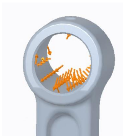
Obrázek 71 - Detail aplikovaného zatížení od tlaku plynů
