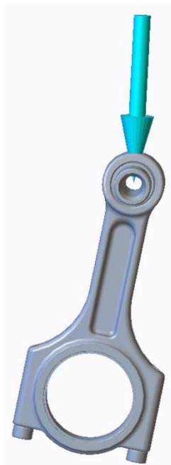
Obrázek 69 - Působení síly na ojnici a pístní čep
