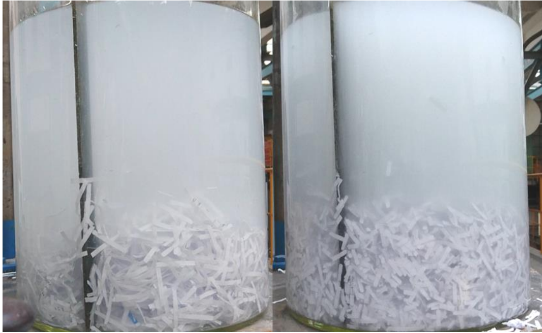
Obr. 28: Vlákenná suspenze o nižší koncentraci (vlevo) a o vyšší koncentraci (vpravo)
