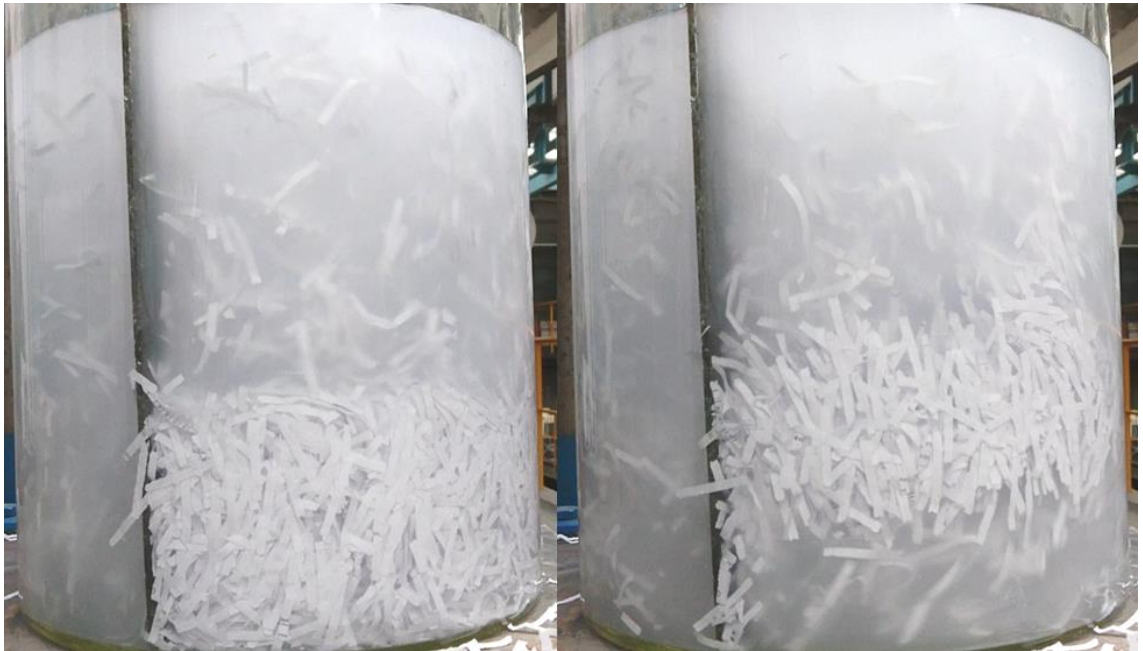
Obr. 29: Částečný vznos (vlevo) a téměř úplná cirkulace (vpravo) míchané vsádky s vyšší koncentrací
