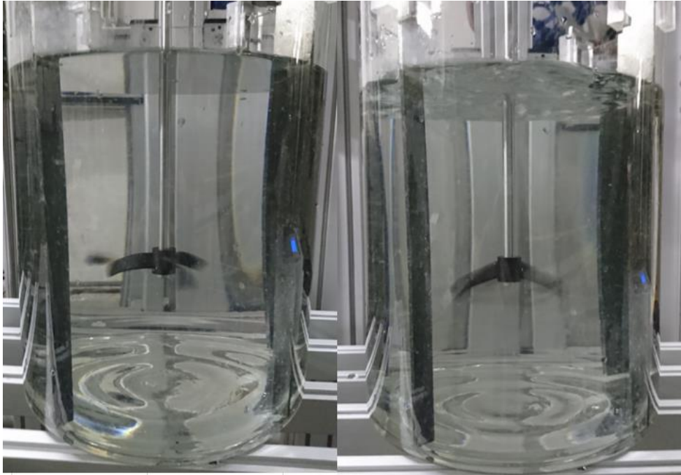
Obr. 25: Průběh měření příkonu míchadel A (vlevo) a B (vpravo)
