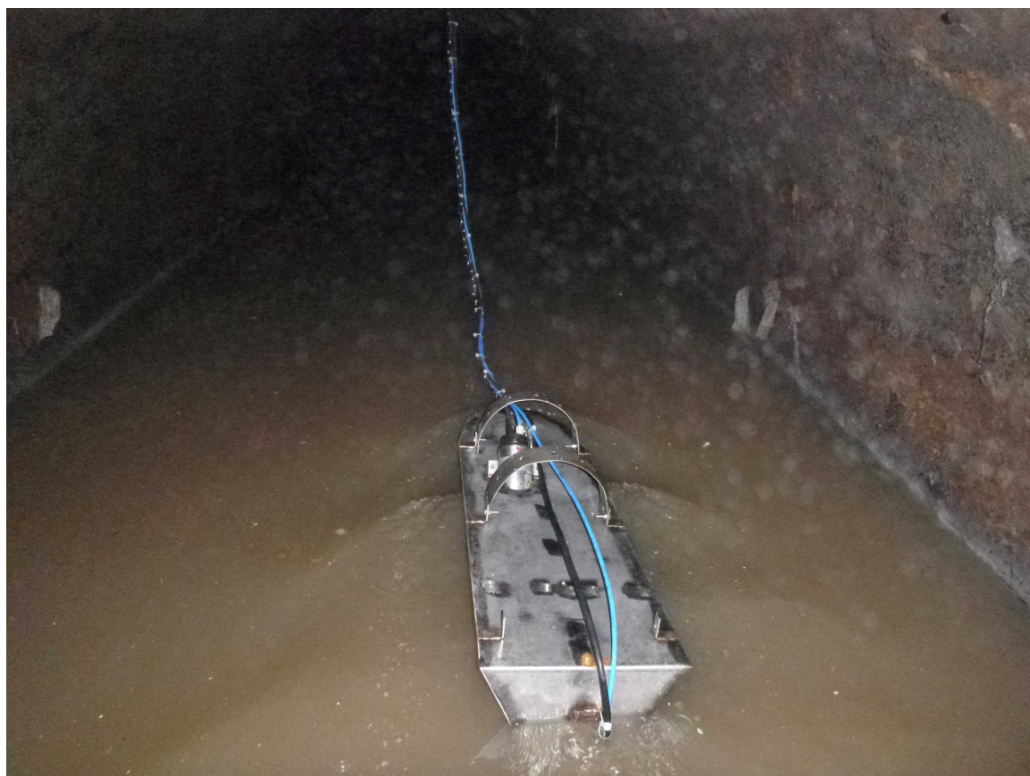
Obrázek 4.2- Plovák se sondou ve stoce (14)
