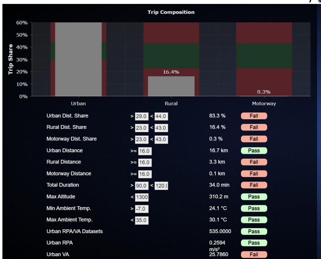
Obr. 77.: Slouží k sledování dat při jízdě slouží Trip Composition
