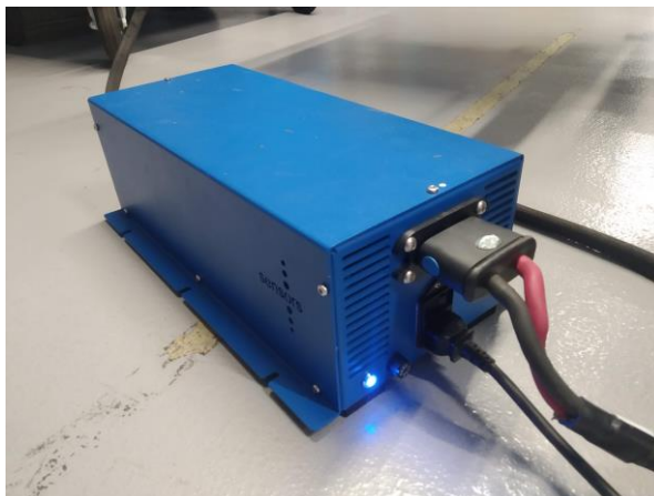
Obr. 74.: SEMTECH napájecí zdroj 12V/ 120A
