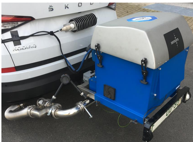
Obr. 19.: PEMS firmy SENSORS umístěný na vozidle
