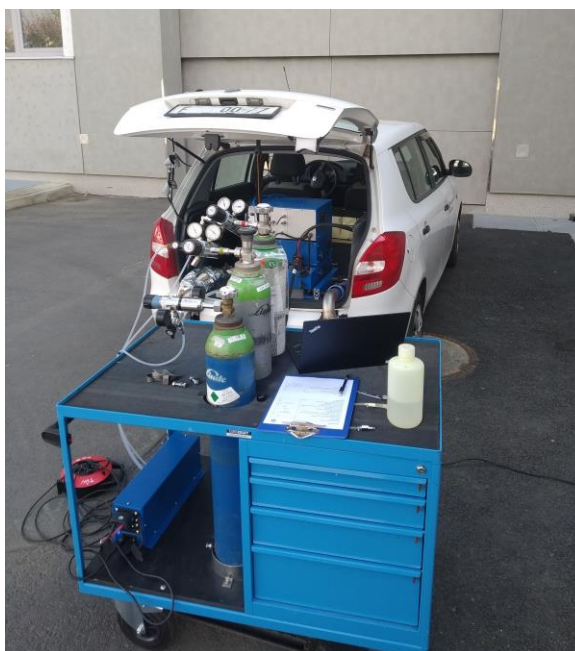
Obr. 43.: Kalibrační plyny v obslužném vozíku při jedné z kalibrací
