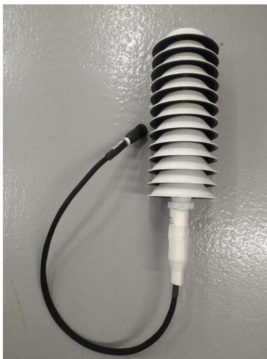
Obr. 73.: Teplotní čidlo VAISALA HSP155
