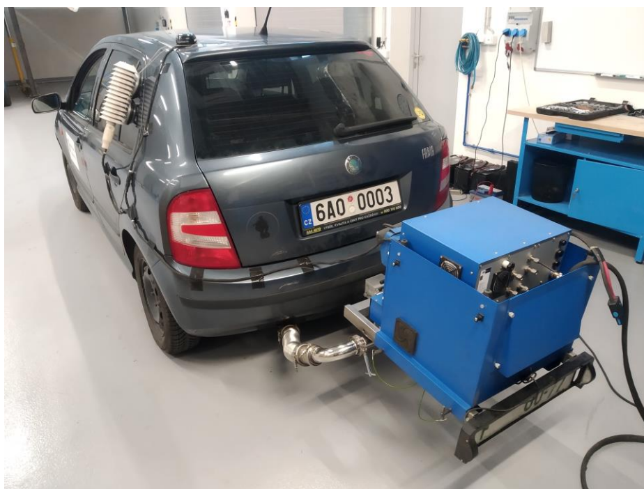
Obr. 22.: PEMS na tažném zařízení: vozidlo Škoda Fabia I
