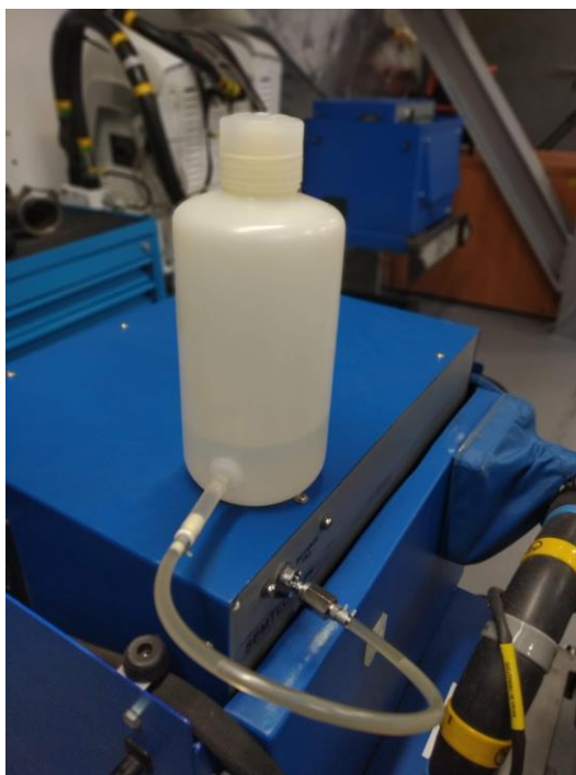
Obr. 49.: Doplnění Butanolu před testem
