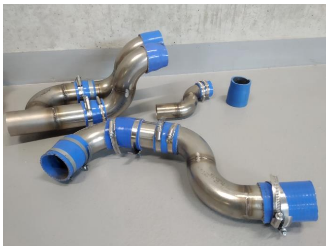
Obr. 24.: Spojovací materiál, který se využívá na napojení výfuku
