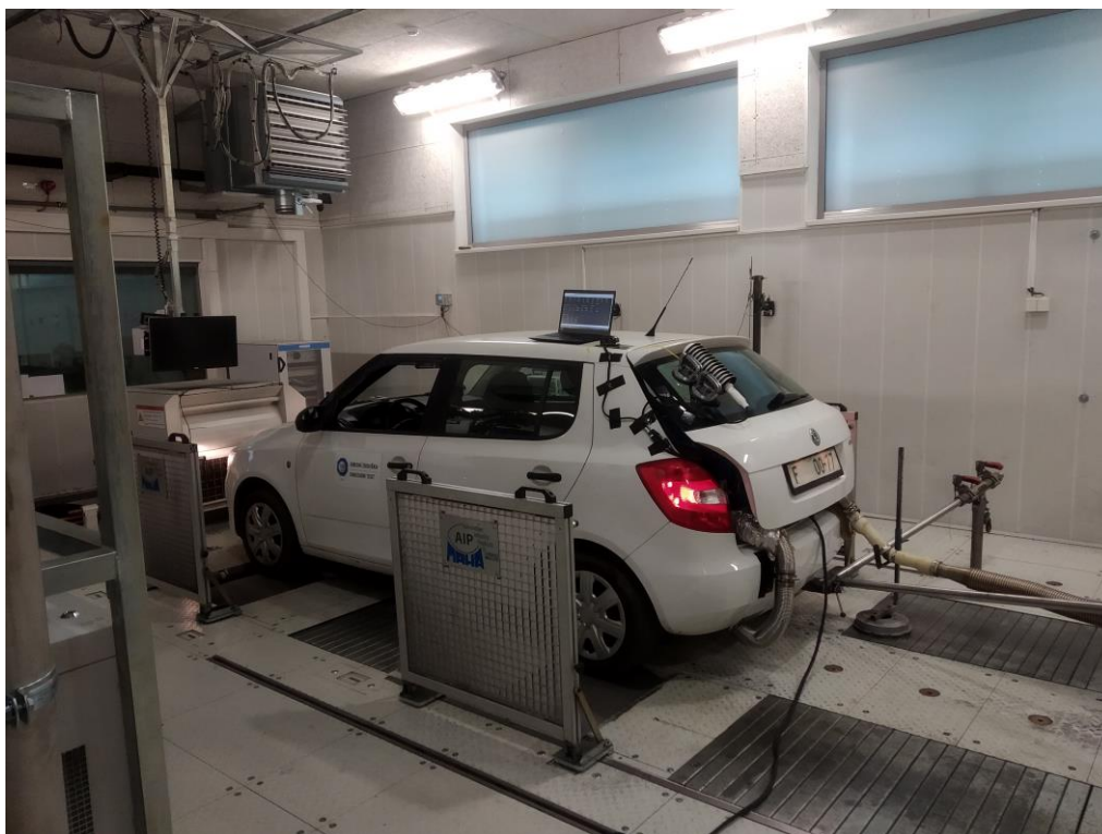
Obr. 10.: Ukotvení vozu na válcovém dynamometru
