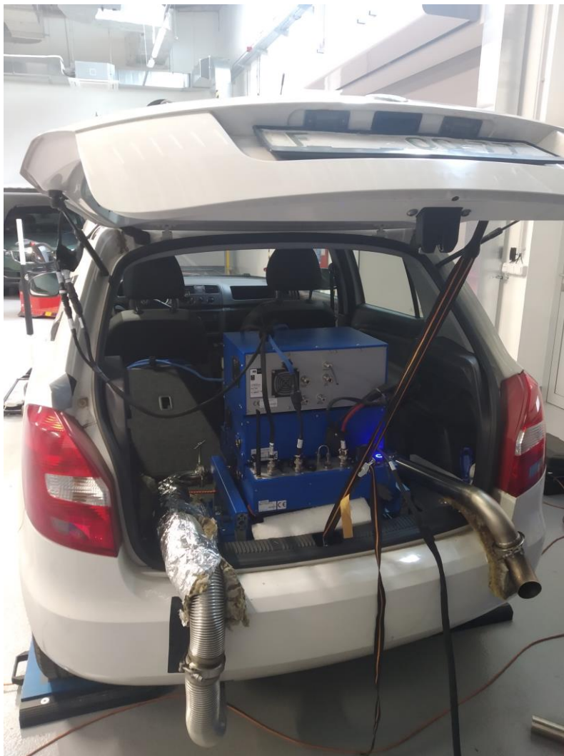
Obr. 23.: PEMS umístěný ve vozidle: vozidlo Škoda Fabia II
