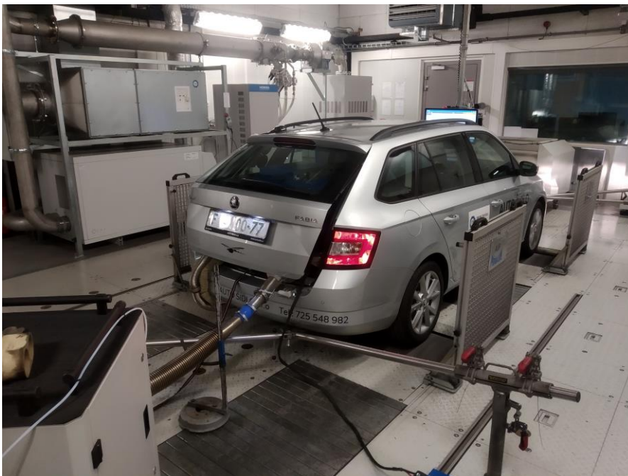
Obr. 4.: Válcový dynamometr MAHA-VTP Rostoky
