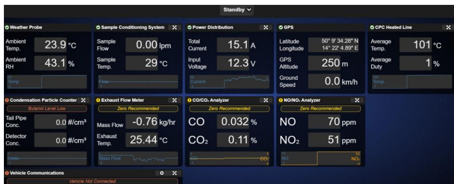
Obr. 44.: Požadavek průtokoměru a analyzátorů na vynulování
