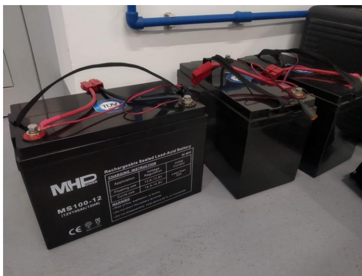
Obr. 75.: Olověná baterie používaná pro napájení PEMS
