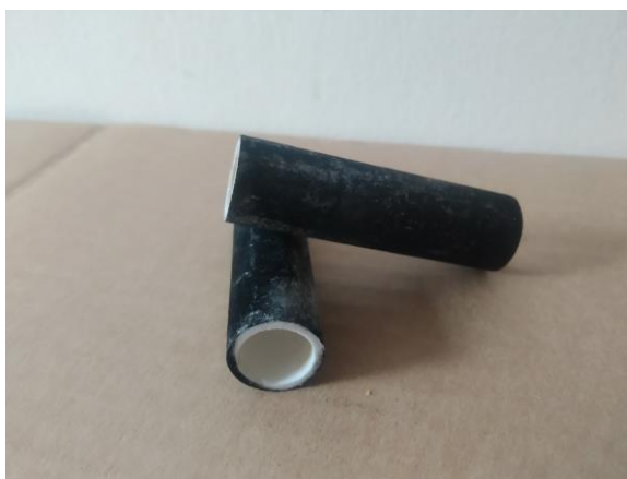
Obr 62.: Stav filtrů po měření s vozidlem Fabia II
