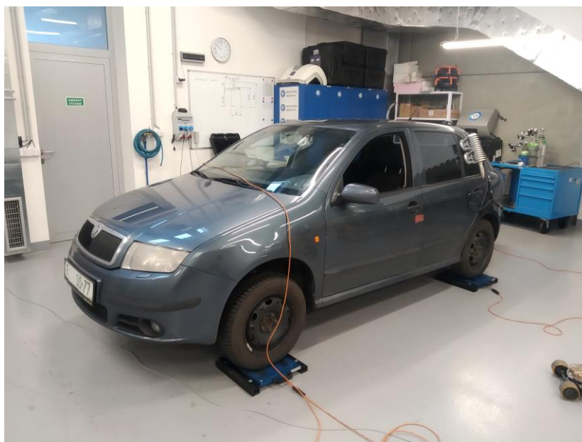
Obr. 60.: Vážení měřeného vozu Škoda Fabia I na kondiční hale
