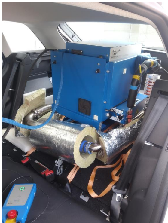
Obr. 36.: Vlevo uchycení PEMS včetně izolačních materiálů ve voze Škoda Fabii III Obr. 37.: Vpravo uchycení ve vozidle Škoda Fabia II
