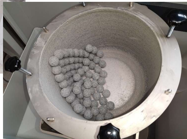
Obr. 9: Vnitřek bubnu s mlecími tělesy po vyprázdnění produktu
