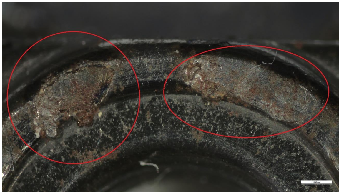
Obrázek 31.: Otlacení způsobené pneumatickým pístem středofrekvenčního svařovacího stroje
