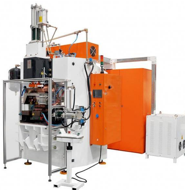
Obrázek 25.: Svařovací kondenzátorový stroj schopný vyvinout přitlačnou sílu 120 kJ [48]
