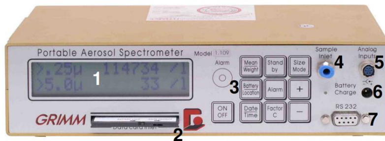
Obr. 24: Přístroj Grimm 1.109 a jeho ovládací panel
