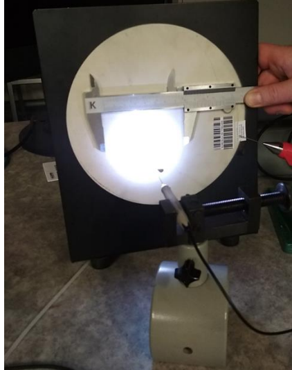
Obrázek 28: Měření NA optického vlákna Alcon určeného k experimentům.
