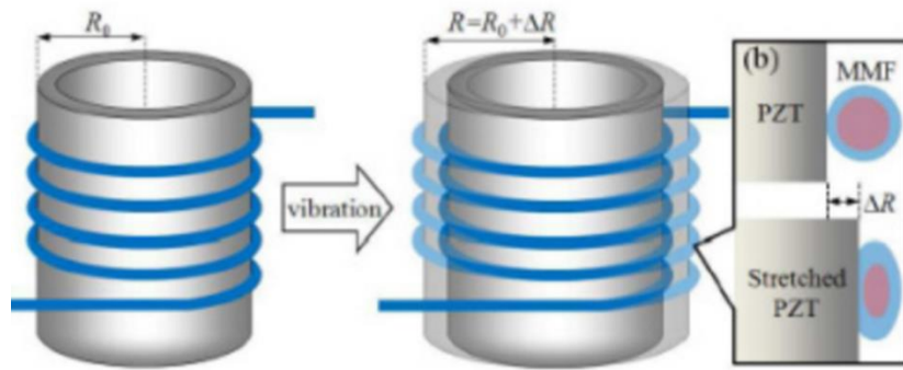
Obrázek 24: Schéma natahování a vibrování optickým vláknem na PZT. [32]
