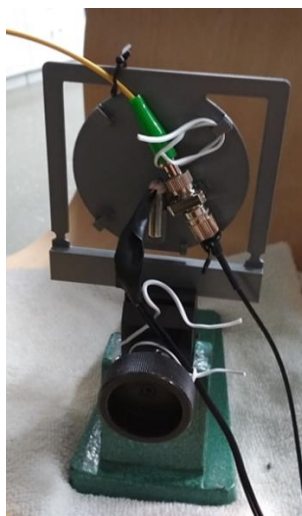
Obrázek 46: Vibrování s konektorem na přípravku II.
