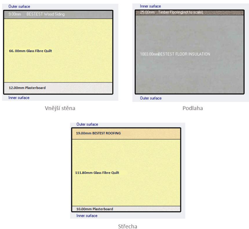
Obr. 4.12 – Grafické znázornění výsledných konstrukcí případu 600
