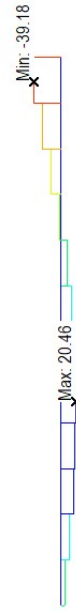
Obrázek 8.9 - Posouvající síla F_z při kombinaci MSÚ na opěře O2 ve fázi III
