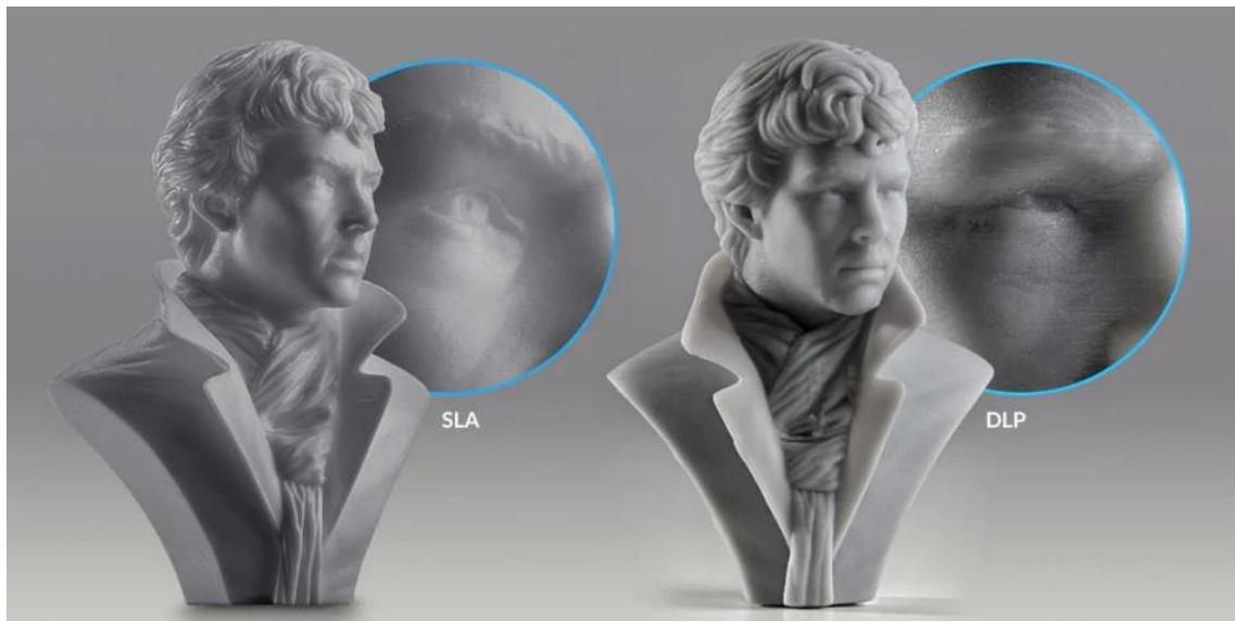
Obrázek 15:Kvalita povrchu SLA vs. DLP [22]
